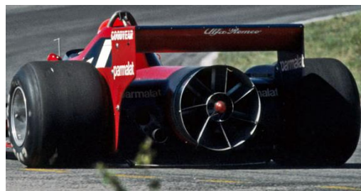
Figura 3-2: Extractor de aire vehículo F1 Brabham BT46B
