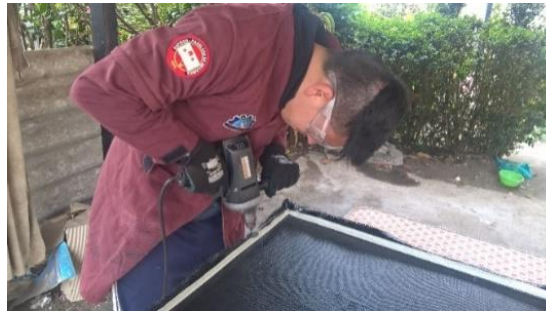
Figura 85-3: Corte de excesos de Material
