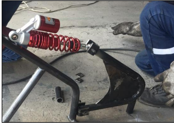
Gráfico 57-4: Ensamblaje provisional de la suspensión trasera. Realizado por: Los autores
