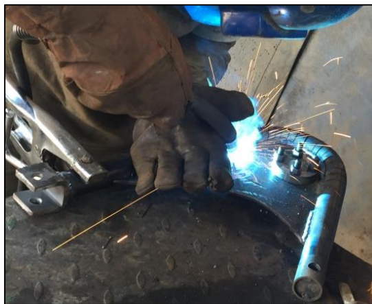
Gráfico 58-4: Ensamblaje final de la suspensión mediante MIG. Realizado por: Los autores
