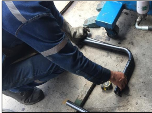
Gráfico 53-4: Doblado de tubo del brazo de suspensión. Realizado por: Los autores
