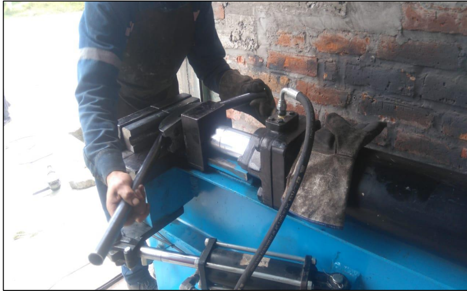
Gráfico 67-4: Doblado del tubo. Realizado por: Los autores
