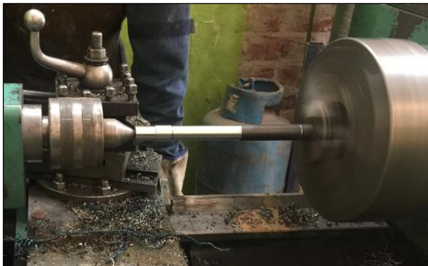
Gráfico 64-4: Torneado parte 2 del semieje. Realizado por: Los autores
