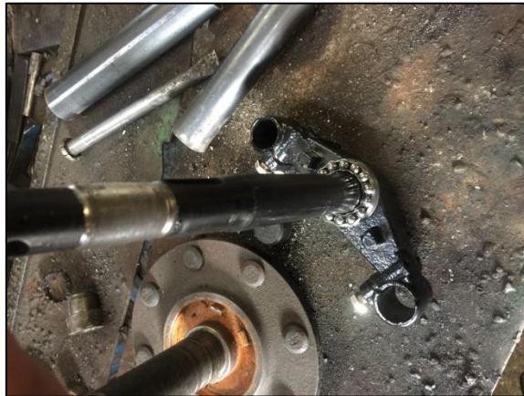
Gráfico 59-4: Fijación de la pista inferior de la dirección. Realizado por: Los autores
