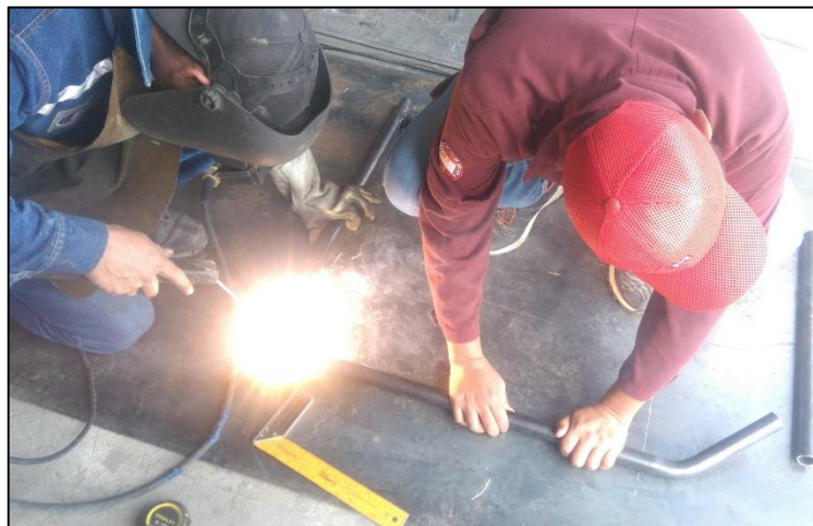
Gráfico 50-4: Ensamblaje de la base mediante soldadura por puntos (SMAW).
