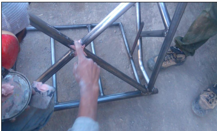
Gráfico 70-4: Masillado de imperfecciones de la estructura del bastidor. Realizado por: Los autores
