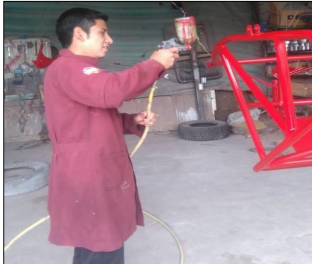
Gráfico 73-4: Aplicación de la pintura de color. Realizado por: Los autores
