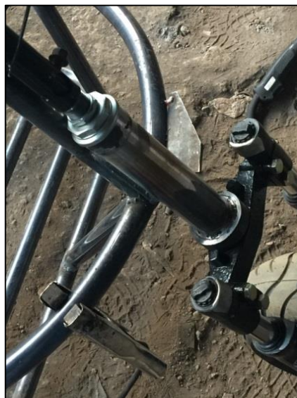
Gráfico 52-4: Implementación de la suspensión delantera. Realizado por: Los autores
