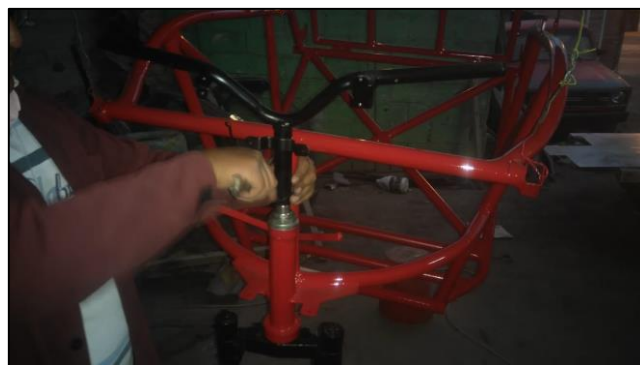
Gráfico 60-4: Fijación del volante de dirección. Realizado por: Los autores
