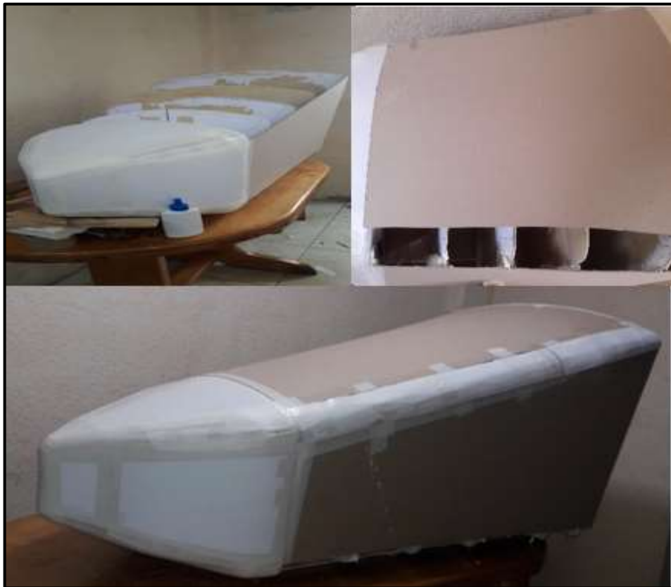
Figura 67-3: Pre-molde terminado Fuente: Autores
