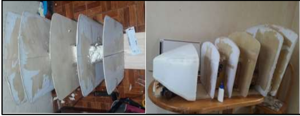
Figura 66-3: División y fijación de los paneles del pre-molde Fuente: Autores
