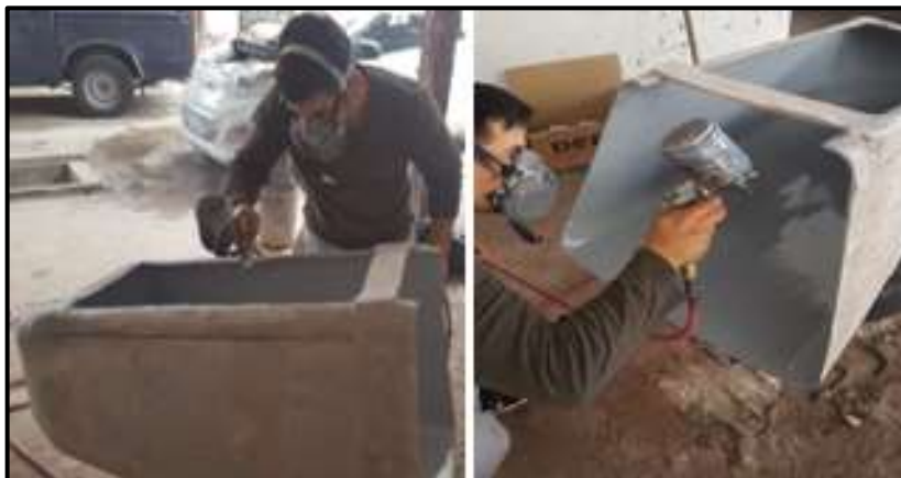
Figura 76-3: Aplicación de pintura y brillo poliuretano
