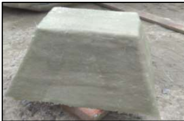
Figura 80-3: Aplicación de la de resina y fibra de vidrio. Fuente: Autores
