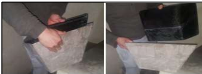
Figura 92-3: Extracción del atenuador de impacto del molde... Fuente: Autores
