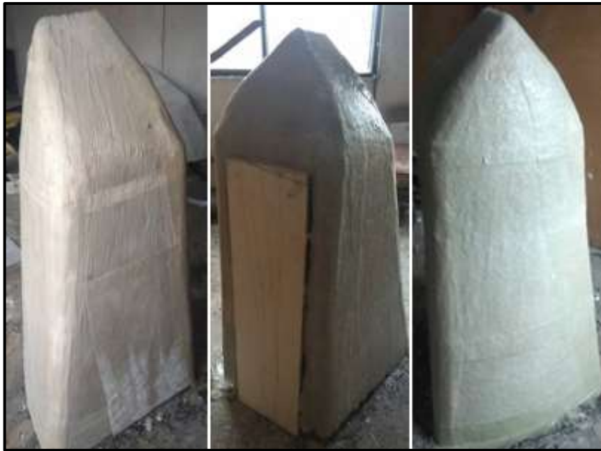
Figura 72-3: Aplicación de la fibra de vidrio al pre-molde
