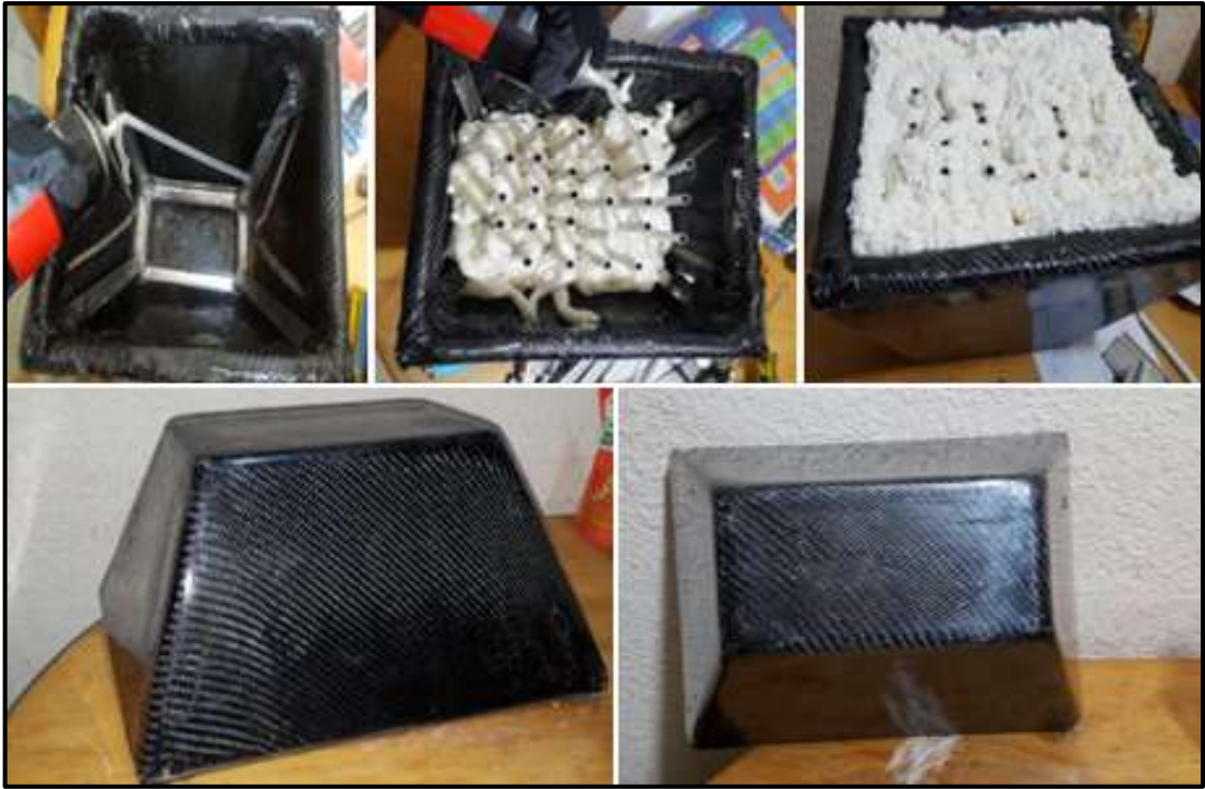
Figura 93-3: Atenuador de impacto culminado Fuente: Autores
