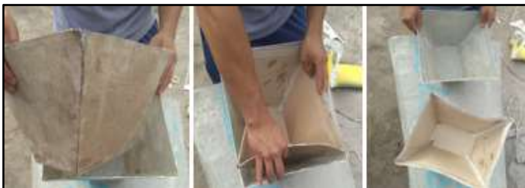
Figura 81-3: Molde del atenuador de impacto Fuente: Autores
