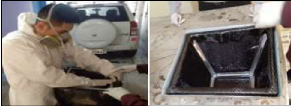
Figura 91-3: Incorporación de la estructura del atenuador de impacto Fuente: Autores
