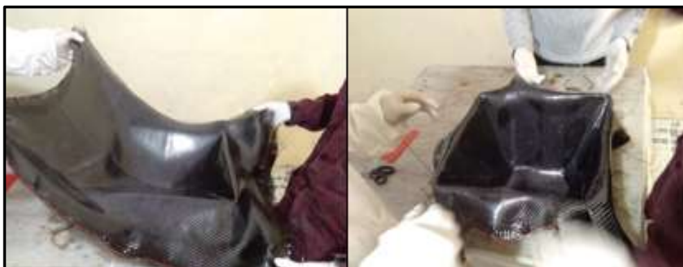
Figura 90-3: Aplicación de la 1er y 2da capa de material compuesto Fuente: Autores
