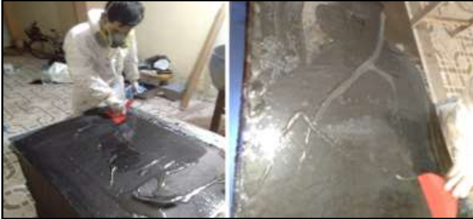
Figura 84-3: Impregnado de la resina y fibra de carbono en una base de vidrio Fuente: Autores
