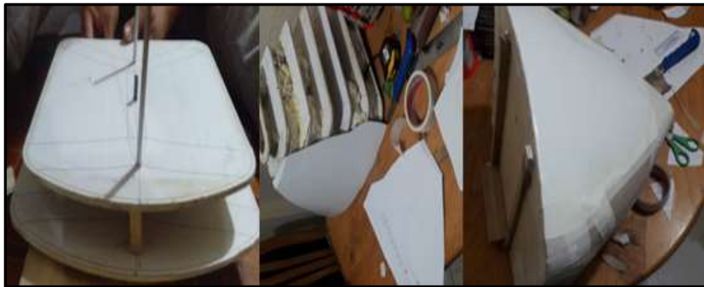
Figura 65-3: Ensamblaje de la parte frontal de trompa de punta redondeada Fuente: Autores
