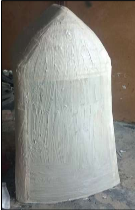
Figura 70-3: Aplicación de yielcold al pre-molde
