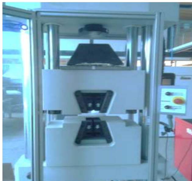
Figura 19-3: Ensayo atenuador de impacto Fuente: Autores
