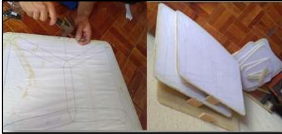
Figura 64-3: Unión de las figuras cortadas y la base del pre-molde Fuente: Autores
