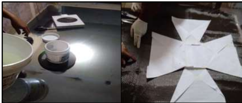
Figura 89-3: Preparación de la fibra de carbono y resina epoxi Fuente: Autores
