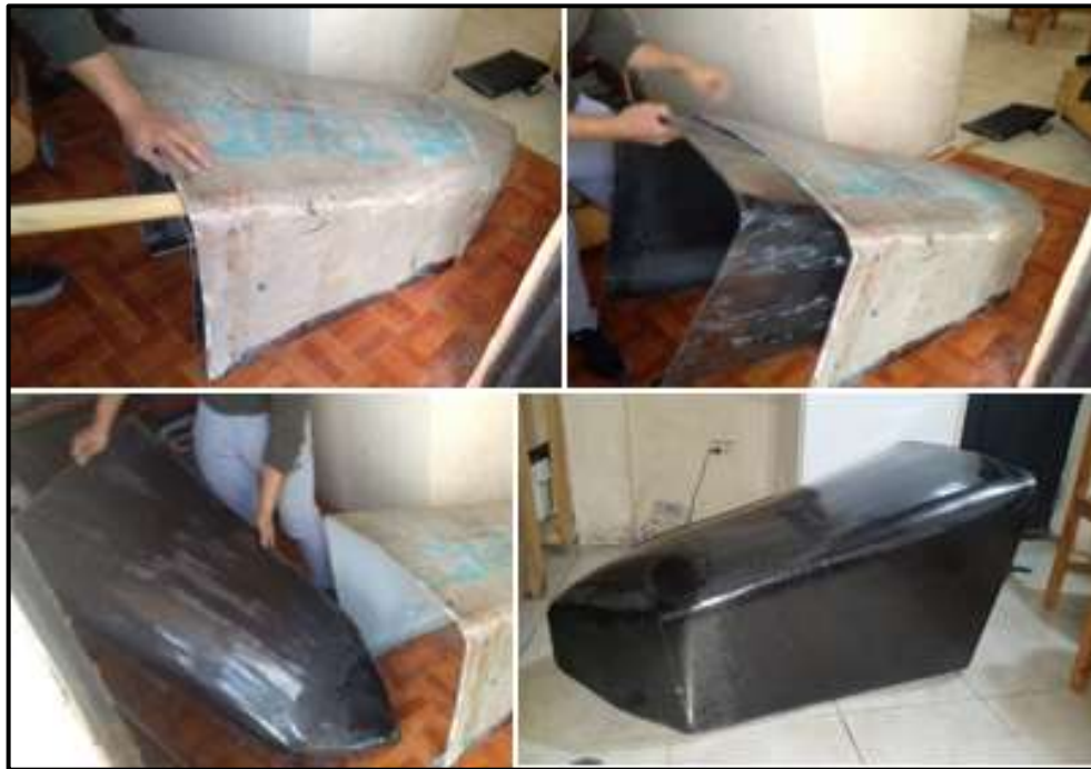
Figura 87-3: Extracción de la matriz del molde Fuente: Autores
