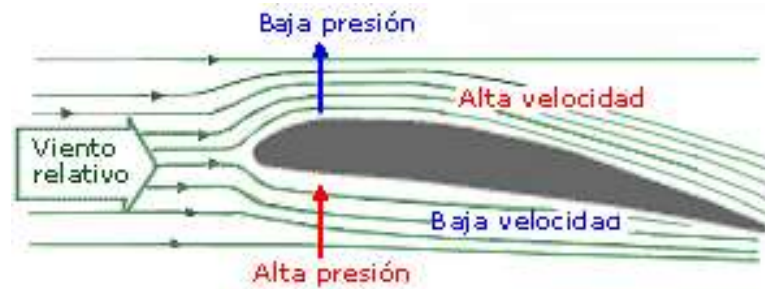
Figura 3-2: Perfil aerodinámico Fuente: (Muñoz, 2018)
