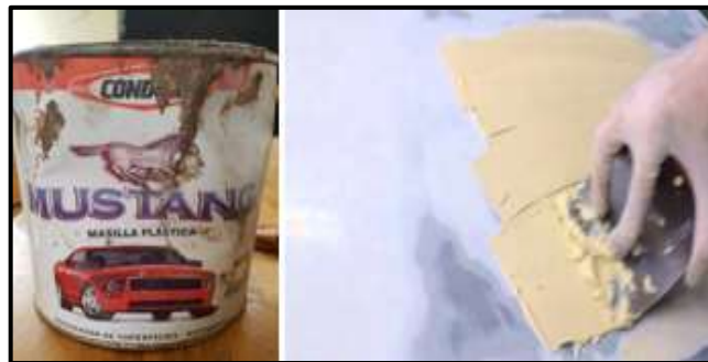
Figura 75-3: Aplicación de la masilla plástica
