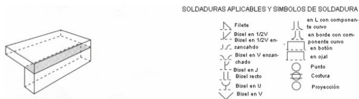
Figura 17-1: Junta Tipo L y la soldadura aplicable
