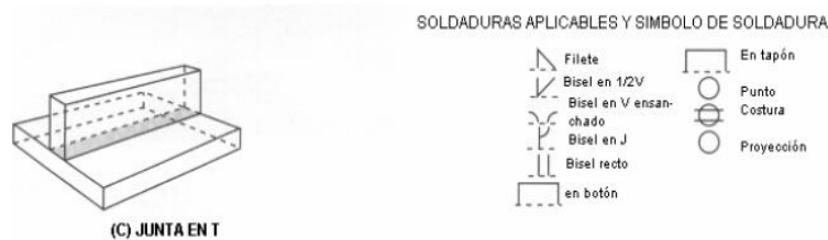
Figura 18-1: Junta Tipo T y la soldadura aplicable.
