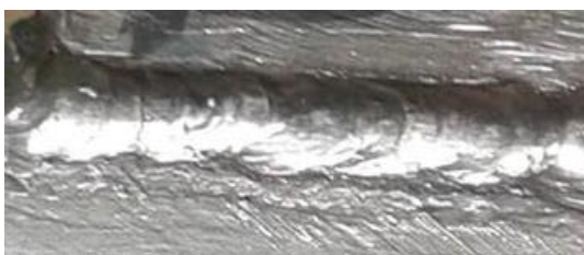
Figura 5-3: Uniformidad del cordón de soldadura en la junta E02.1
