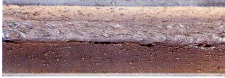
Figura 46-1: Socavación Adyacente en una Soldadura de Filete Fuente: Adalberto Ruiz
