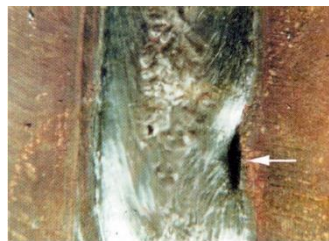
Figura 45-1: Falta de Fusión en la superficie de la Soldadura
