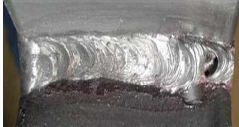
Figura 7-3: Porosidad en la junta soldada E03.1 Realizado por: Autores, 2018
