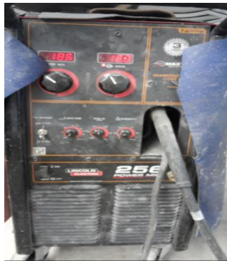
Figura 3-2: Equipo utilizado para la soldadura GMAW Fuente: Autores, 2018
