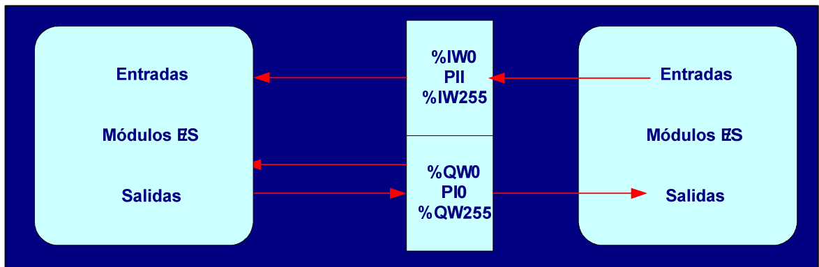
Figura N° III.19: Intercambio de datos entre la funcionalidad del PLC (CPU).
