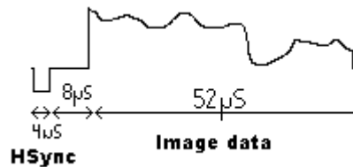
Figura II. 7. Cuadro del "osciloscopio" - de una explorar-línea
