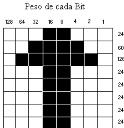
Figura IV. 30. Codificación de una flecha imagen 2 tonos
