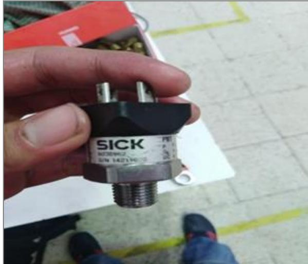
**Figura 2-3:** Representación gráfica del transductor de presión SICK.
