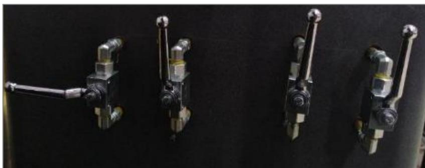
**Figura 10-2:** Válvulas hidráulicas
