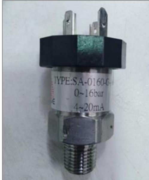
**Figura 3-3:** Representación gráfica del transductor de presión SAFE GAUGE.
