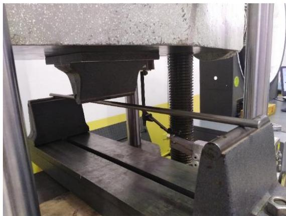
**Figura 9-4:** Instalación del banco de apoyos y probetas
