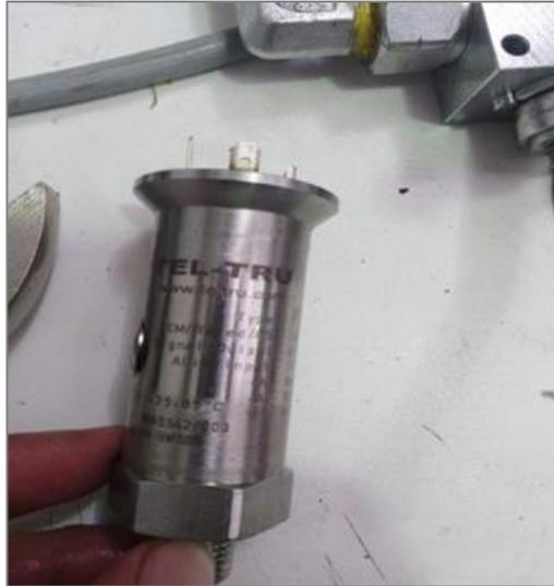
**Figura 1-3:** Representación gráfica del transductor de presión Tel-tru.
