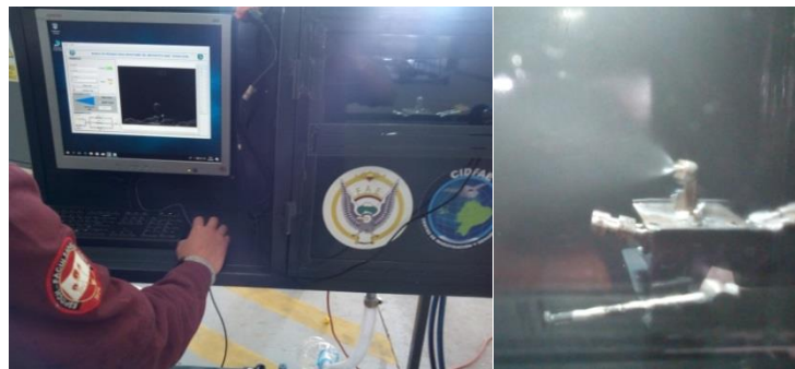
Figura 25-4: Inspección del cono pulverizado
