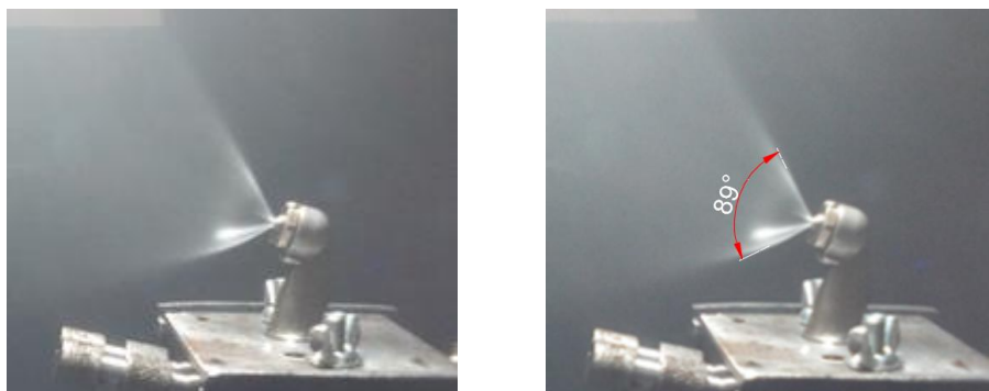
Figura 9-4: Medición del ángulo con inyector dúplex a 60 psi en línea secundaria
