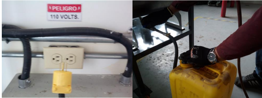
Figura 27-4: Desconexión y drenaje de combustible
