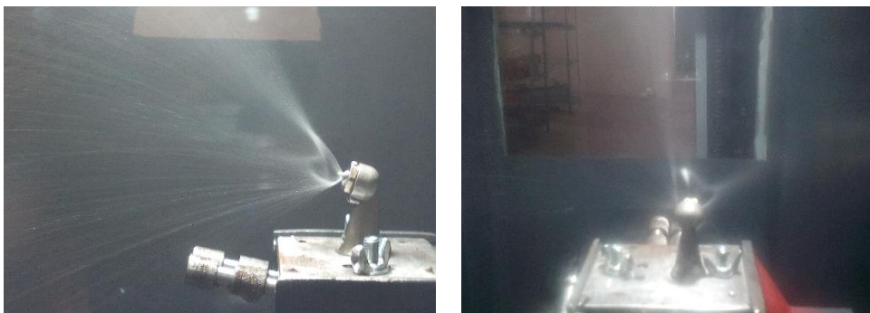
Figura 11-4: Defecto por goteo presente en inyector dúplex a 60 psi
