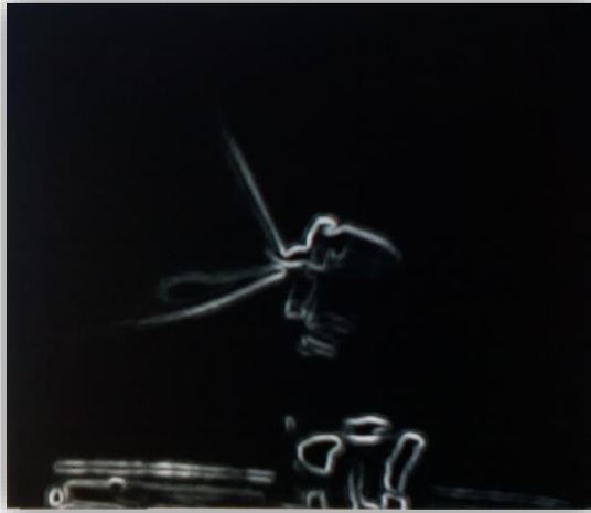
Figura 10-4: Visualización de contorno del inyector dúplex y sus aristas mediante visión artificial a 60 psi en línea primaria
