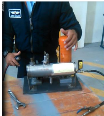
Figura 3-3: Banco de pruebas listo para la inspección
