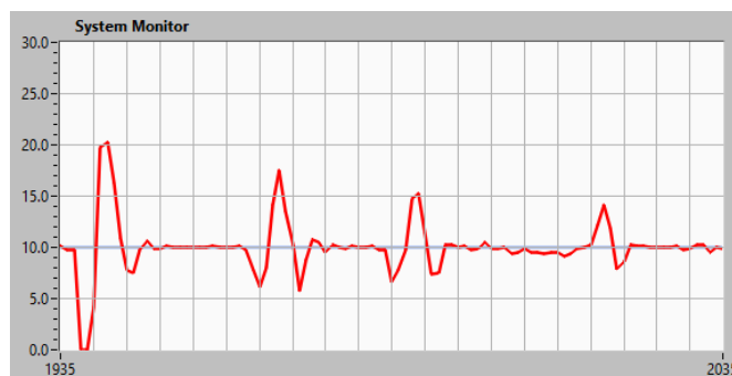
Figura 56-4 Comportamiento del controlador PID a perturbaciones
