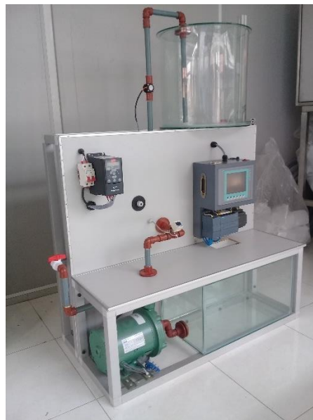
Figura 1-3 Módulo didáctico para control de caudal de agua Fuente: Autores.
