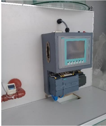
Figura 18-3 Pantalla HMI, PLC-1200 Fuente: Autores.
