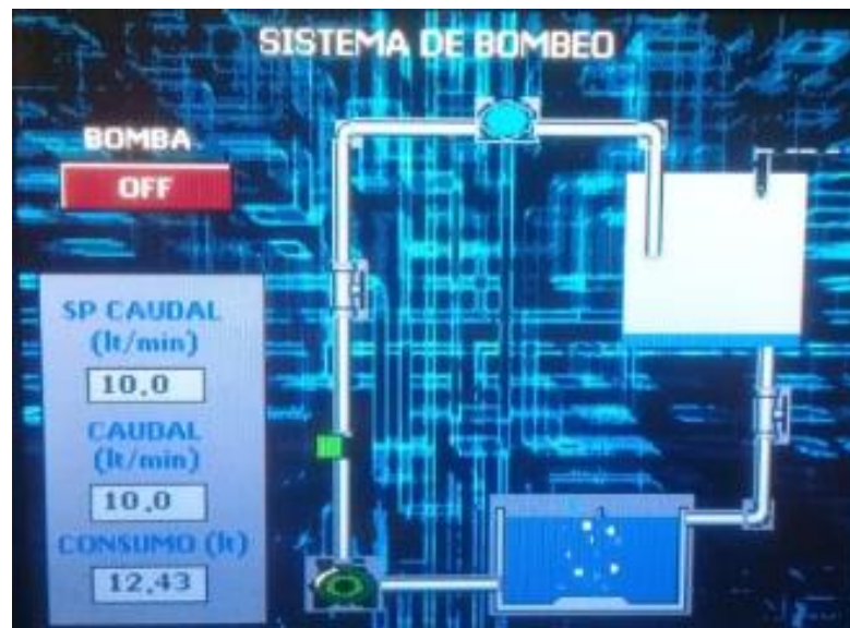
Figura 57-4 Pantalla HMI Fuente: Autores.
