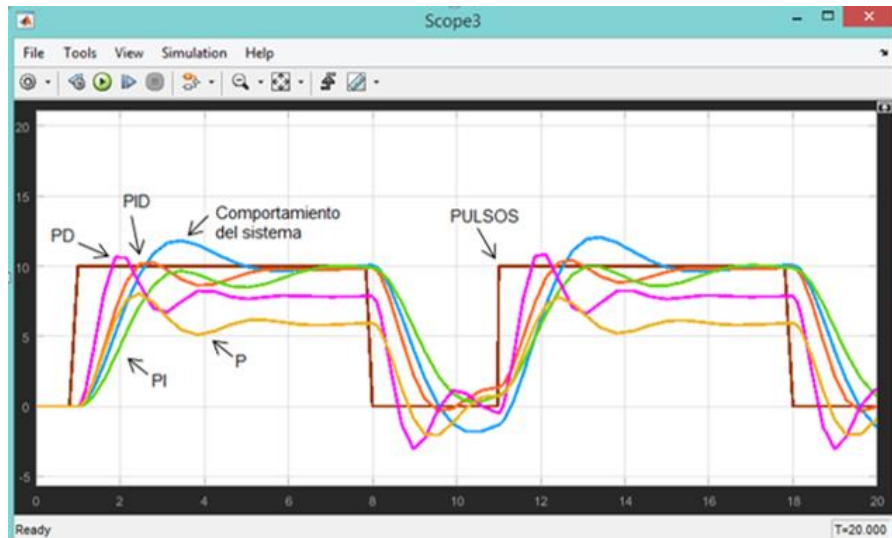
Figura 51-4 Comportamiento del sistema simulink/Matlab Fuente: Autores.
