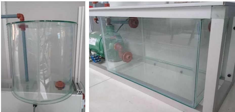
Figura 15-3 Tanques de succión y descarga Fuente: Autores.
