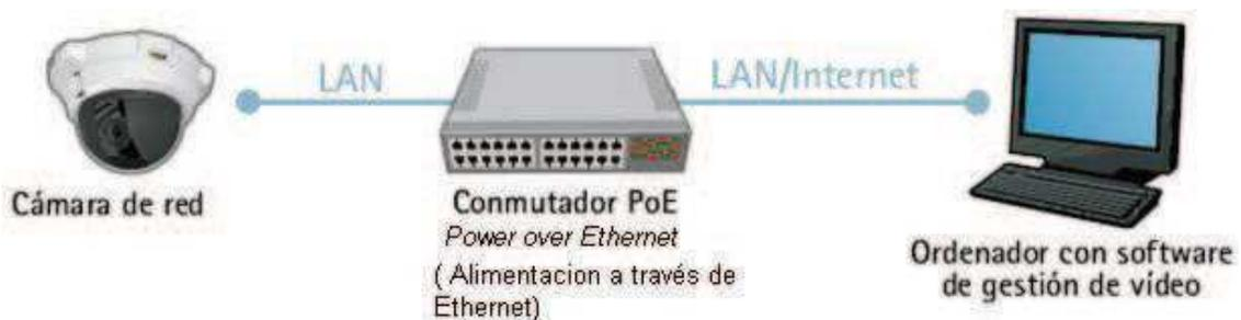
**Fig. 5.1:** Cámara de red conectada directamente a la red LAN.
