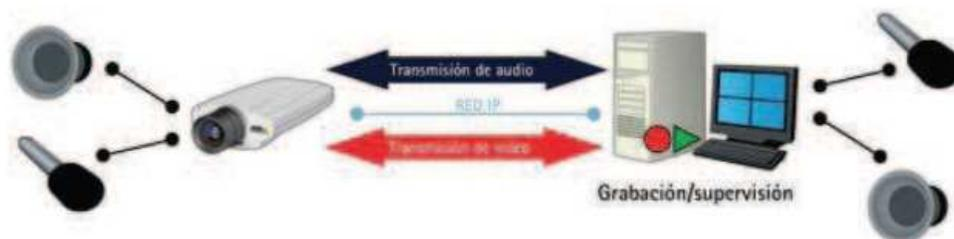
**Fig. 5.17:** Sistema de cámara IP con soporte de audio integrado
