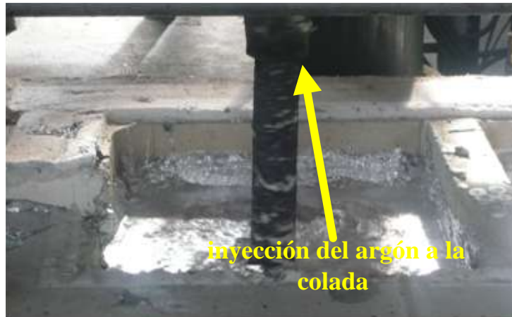
Figura 14. Entrada de Argón para la Mezcla Homogénea.
