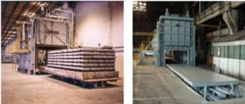
Figura 48. Hornos Tipo por Lotes: a) de Vagoneta; b) de Bandeja.
