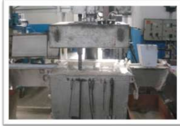
Figura 31. Unidad Desgasificadora Donde se Añade (Ti-Bor).
