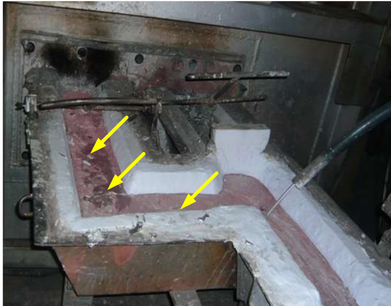
Figura 88. Oxidación de la Superficie de aluminio.
