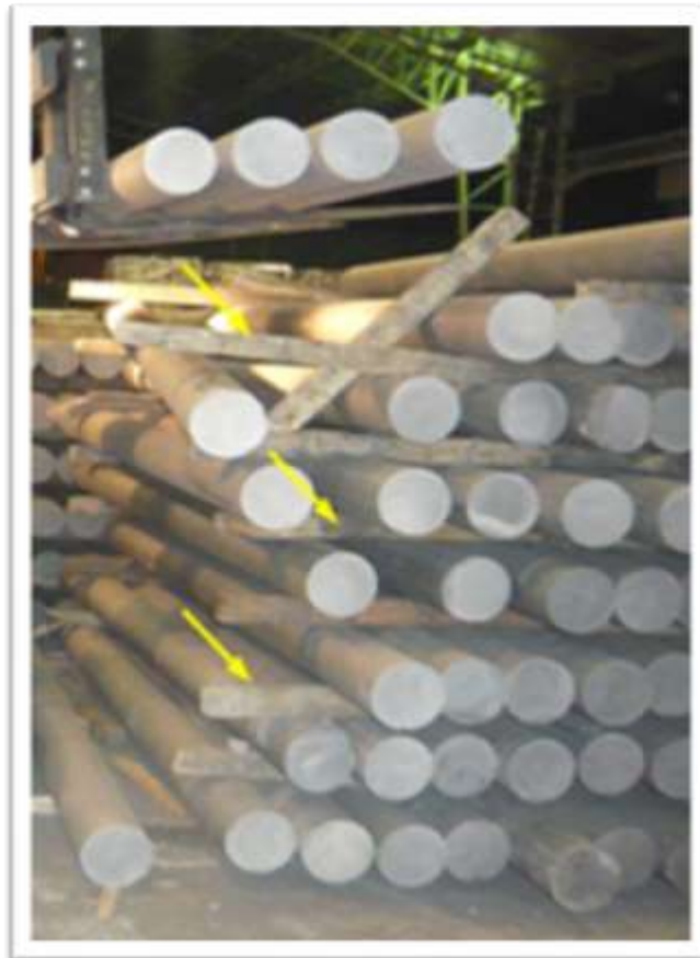
Figura 69. Separador Transversal (actual).
