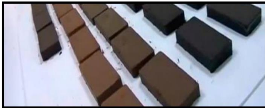
Figura 3-1: Ladrillos cerámicos producto de la solidificación de Lodos Industriales
