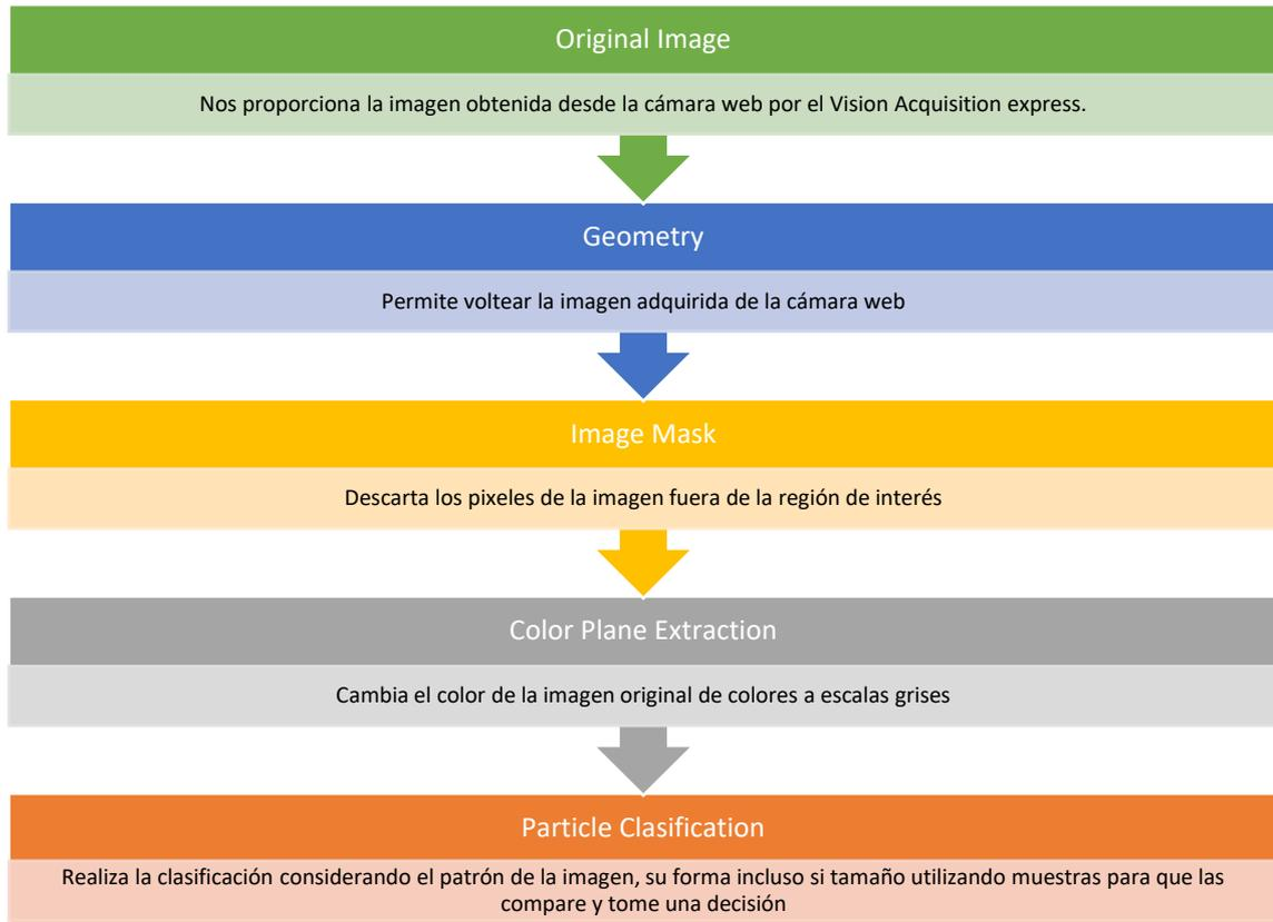
**Gráfico 1-2:** Bloques utilizados para el procesamiento de Imagen en LabVIEW
