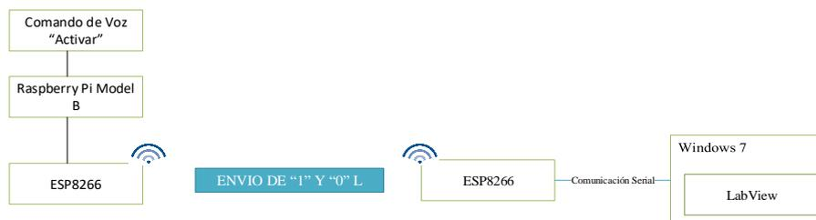
**Figura 49-2:** Enlace inalámbrico entre los comandos de voz y LabView
