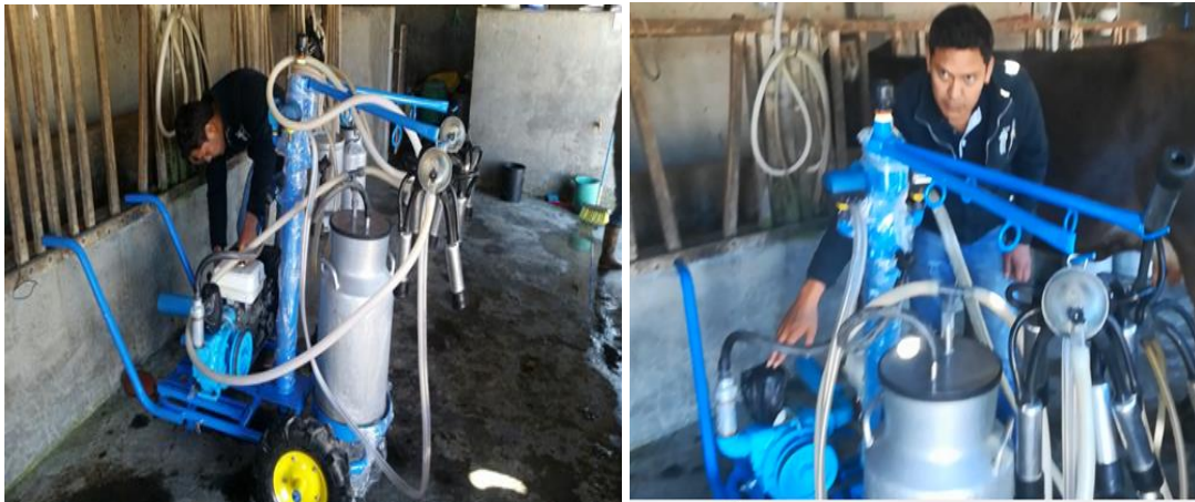
Figura 28-4. Pruebas de funcionamiento del sistema de ordeño
