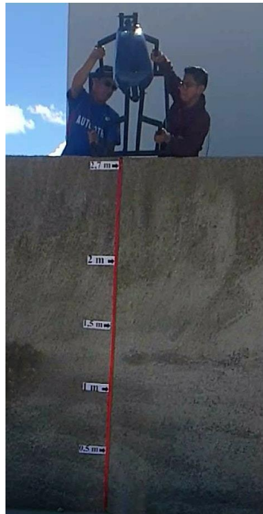
Figura 11-3: Depósito de combustible previo al ensayo.
