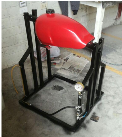
Figura 1-3: Depósito de combustible previo al ensayo.
