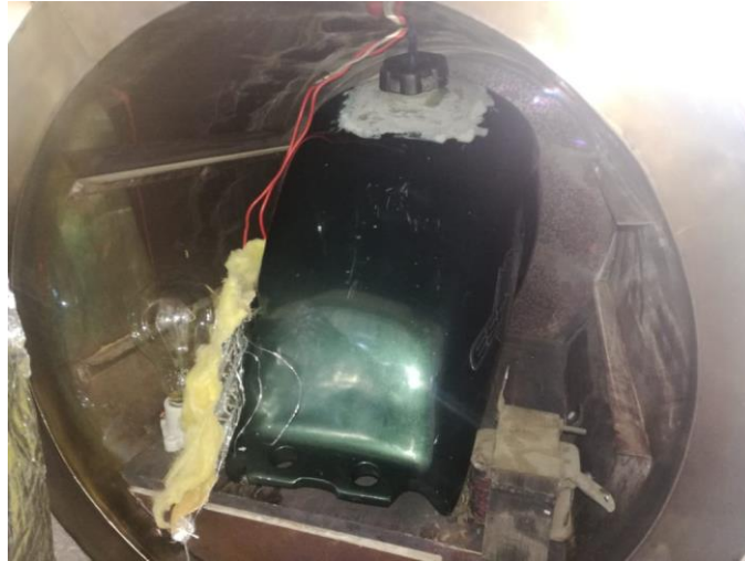
Figura 3-3: Depósito de combustible dentro del Horno-mufla
