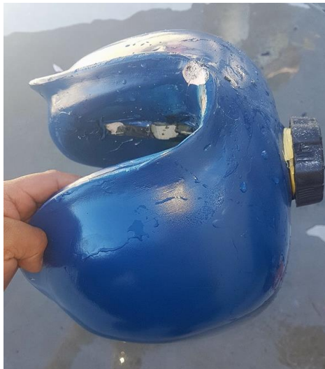
Figura 13-3: Fugas en las uniones del depósito de combustible.
