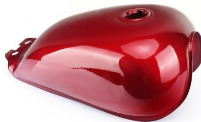
Figura 3-1: Depósito de combustible
