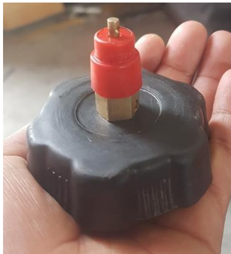
Figura 6-3: Mecanismo liberador de presión instalado en la tapa de combustible
