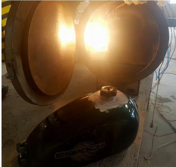
Figura 17-3: Depósito de combustible después del ensayo
