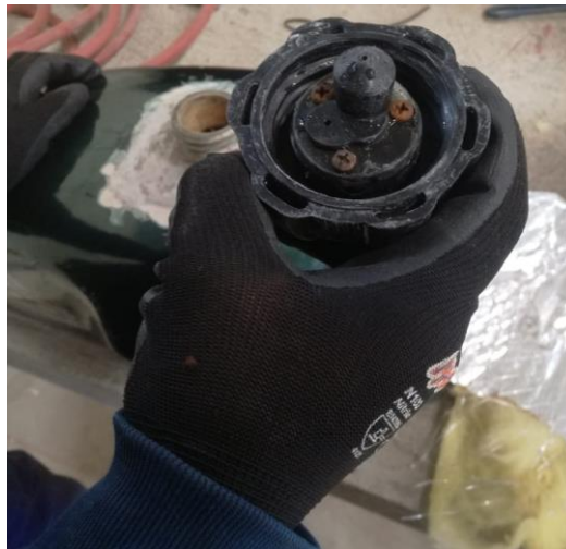
Figura 16-3: Tapa del depósito de combustible después del ensayo
