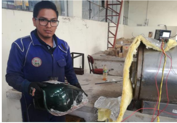
Figura 4-3: Depósito de combustible al concluir el ensayo
