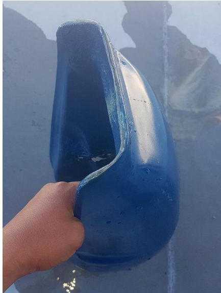
Figura 12-3: Depósito de combustible luego del ensayo
