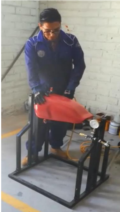
Figura 7-3: Depósito de combustible previo al ensayo.
