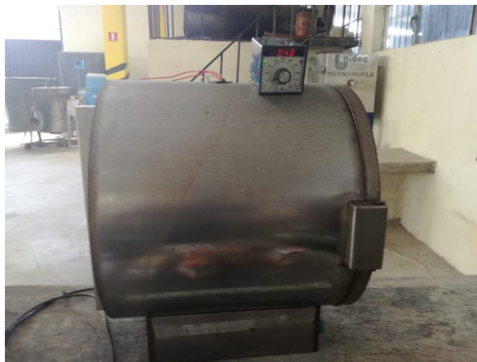
Figura 2-3: Depósito de combustible dentro del Horno-mufla ( 40^{\circ}\text{C} )
