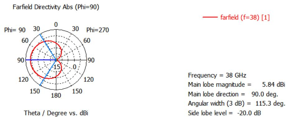
**Figura 76-4.** Patrón de radiación del elemento radiante unitario en coordenadas polares optimizado tipo parche tree.
