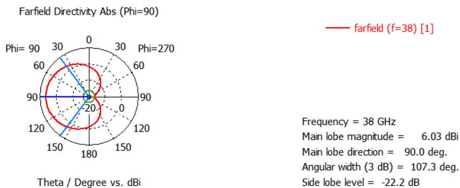
**Figura 70-4.** Patrón de radiación del elemento radiante unitario en coordenadas polares optimizado tipo parche clover.
