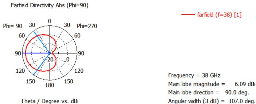
**Figura 67-4.** Patrón de radiación del elemento radiante unitario en coordenadas polares optimizado tipo parche rectangular.
