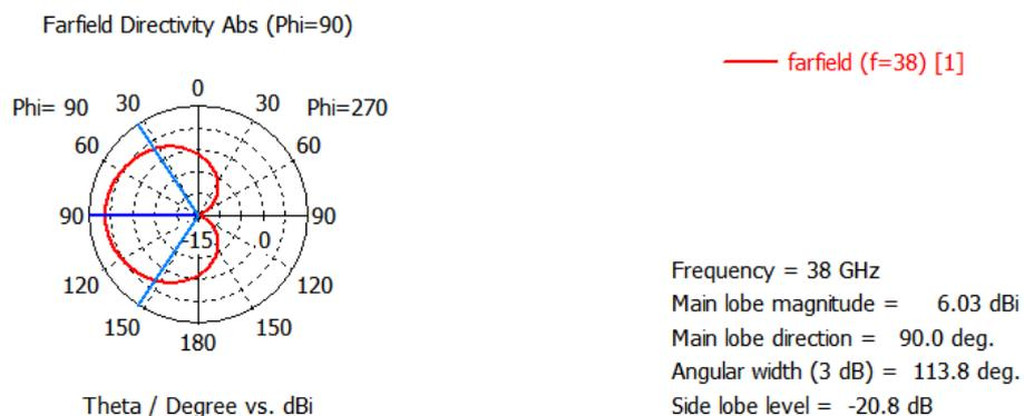
**Figura 85-4.** Patrón de radiación del elemento radiante unitario en coordenadas polares optimizado tipo parche espiral.
