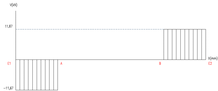
Gráfico 25-4: Diagrama de cortantes “xy” del eje de la barra inferior del elevador
