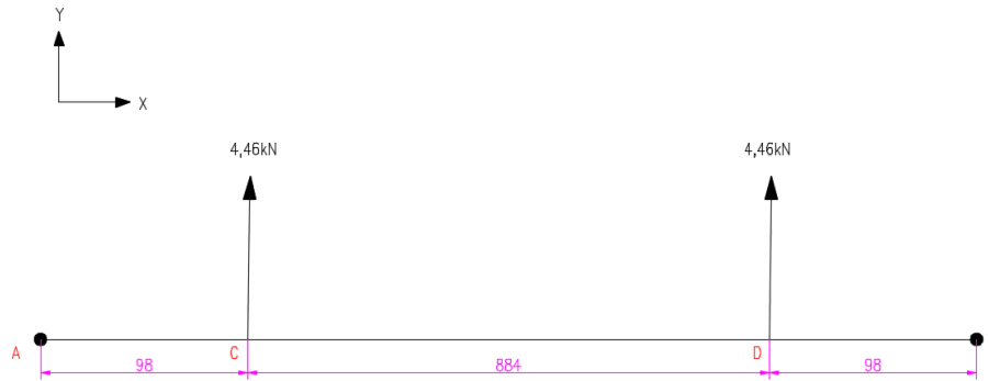
Gráfico 31-4: Diagrama de cuerpo libre en el plano “xy” de la barra de transmisión
