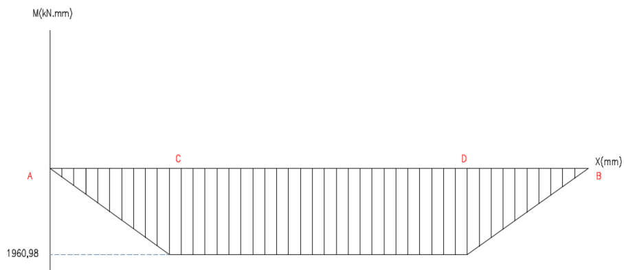
Gráfico 36-4: Diagrama de momentos de la barra de transmisión del elevador
