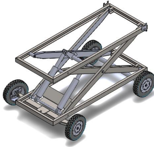
Figura 2-6: Sistema de elevación
