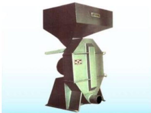
Figura 1-3: Molino de martillos fabricado por Maquinaria Ordoñez
