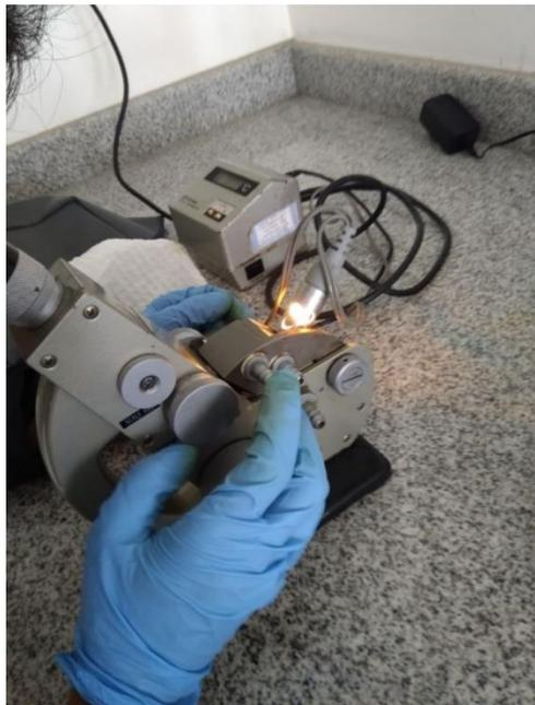
**Gráfico 5B:** Medición del Índice de Refracción
