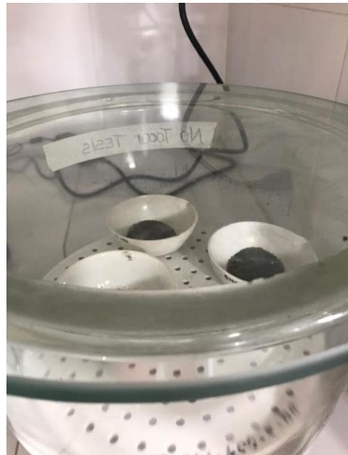
**Gráfico 4B:** Desechado para la determinación de cenizas
