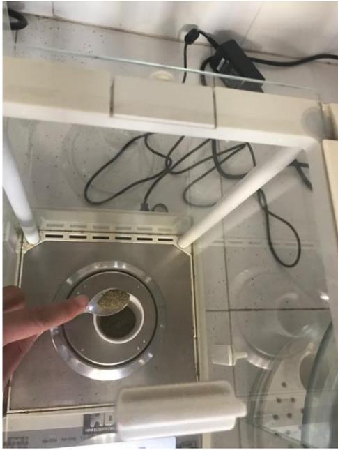
**Gráfico 13B:** Pesada de la muestra para realizar cenizas
