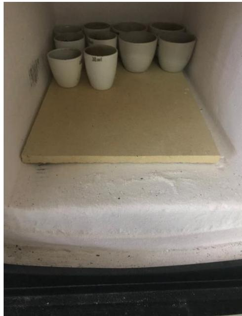
**Gráfico 12B:** Incineración en mufla de cenizas
