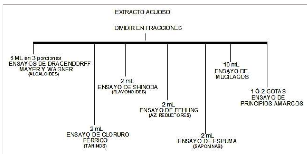
Figura 8-2: Protocolo para realizar el tamizaje fitoquímico de extracto acuoso
