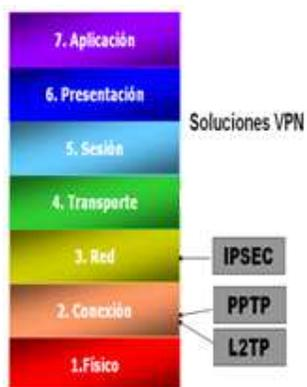
Figura III.1: VPN en el Modelo OSI
