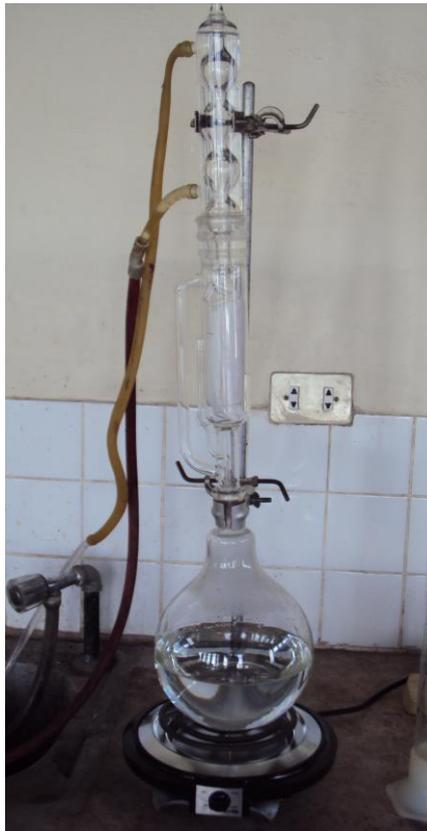
Figura 3. Proceso de extracción continua mediante Soxhlet.
