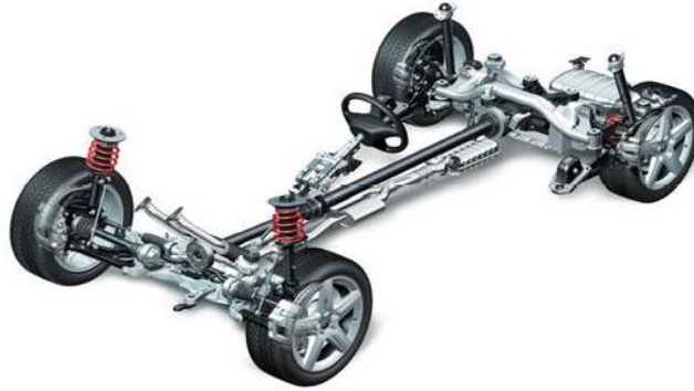
Figura 2.2: Esquema de los Trenes y Suspensión.
