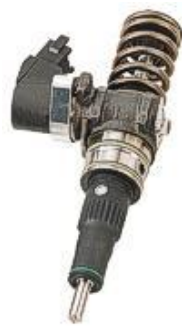
Figura 2.24: Tobera de Inyección Diesel.
