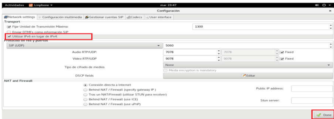
Figura 17-3: Configuración de red en LINPHONE para habilitar IPv6. Realizado por: Quintero Hermes, 2019.
