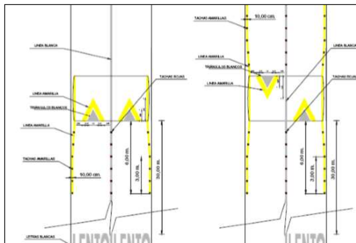
Figura 8-2 Bandas Transversales Alertadoras Diseño geométrico.
