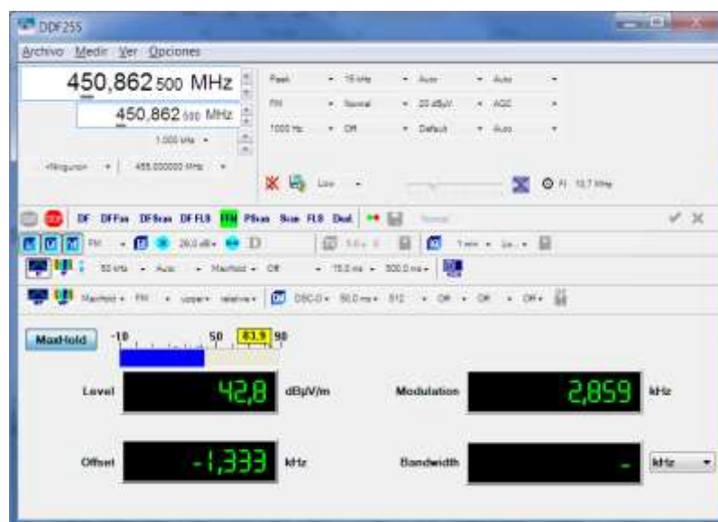
Gráfico 5-4 Configuración estación SACER para medir la banda 450.86 MHz Realizado por: Jacqueline Ponce, 2018
