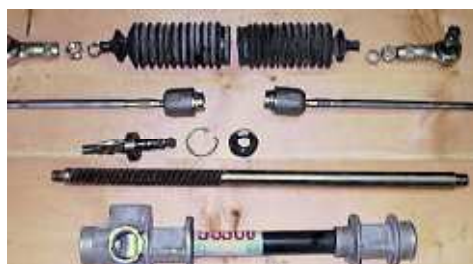
Figura 4.2: Despiece de la cremallera de la dirección
