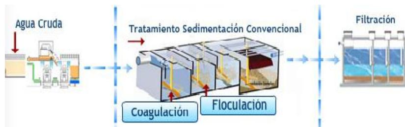
**Figura 7-2:** Filtración Convencional
