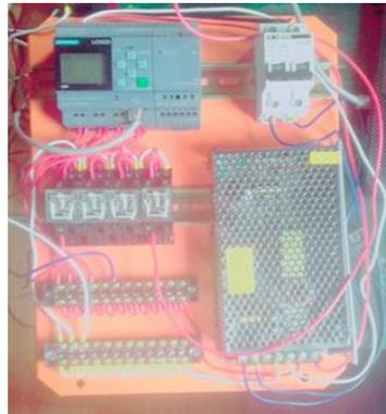
**Figura 62-4:** Conexiones eléctricas de caja de mando.
