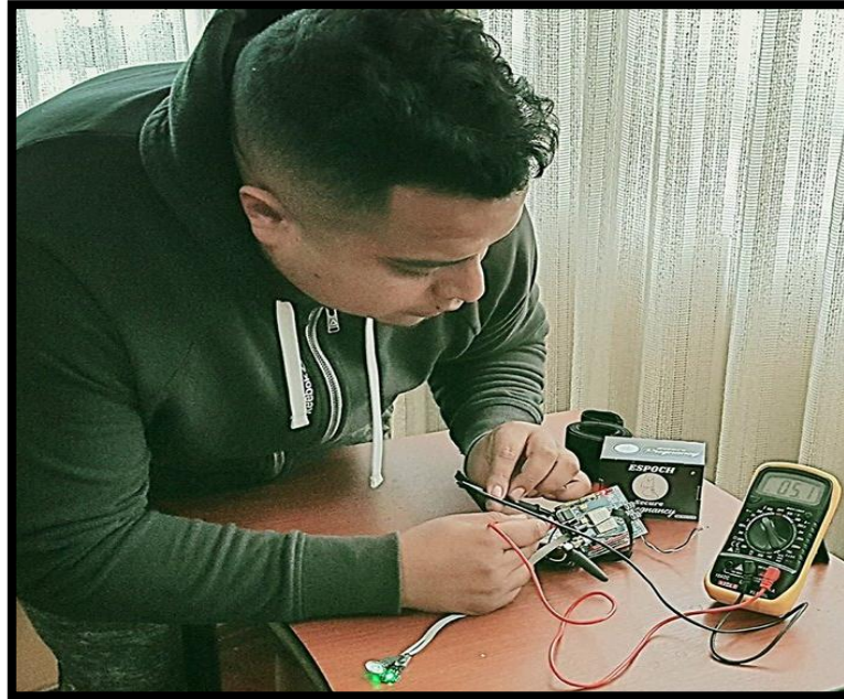
Figura 9-3. Medición de corrientes del prototipo de supervisión. Realizado por: Flores, Alex, 2018.
