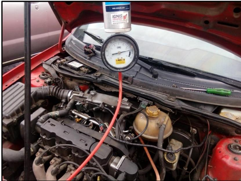
**Figura 34-3. Acoplamiento del canister**
