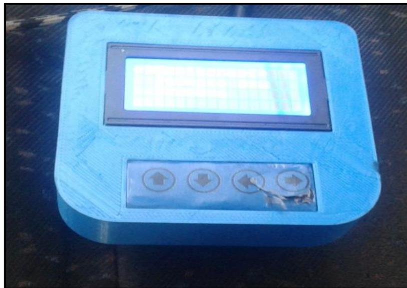
**Figura 24-3.** Ensamble final de la parte de control
