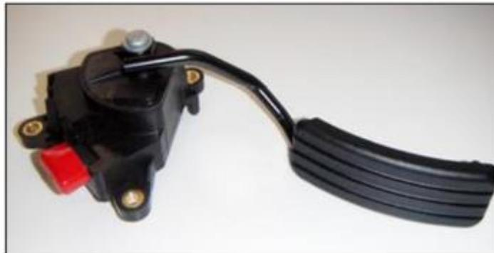
**Figura 8-2.** Pedal del acelerador
