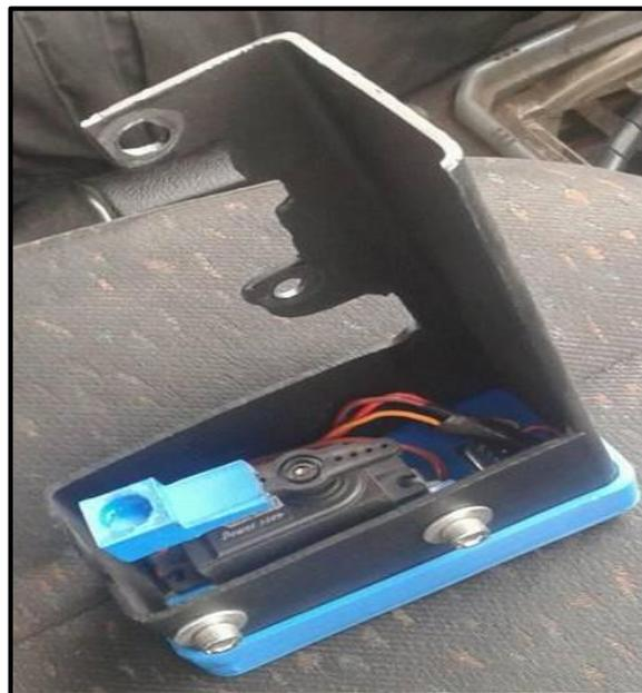
**Figura 26-3.** Ensamble base del servomotor
