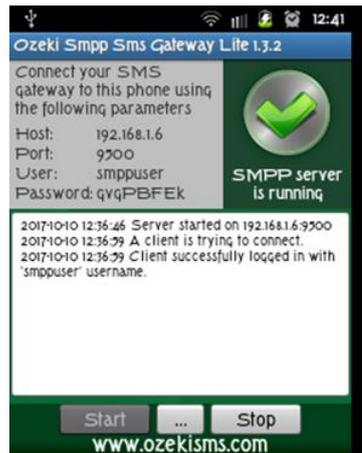
Como se observa en la pantalla se obtiene los siguientes parámetros a utilizar en el software Ozeki SMPP SMS Gateway.
