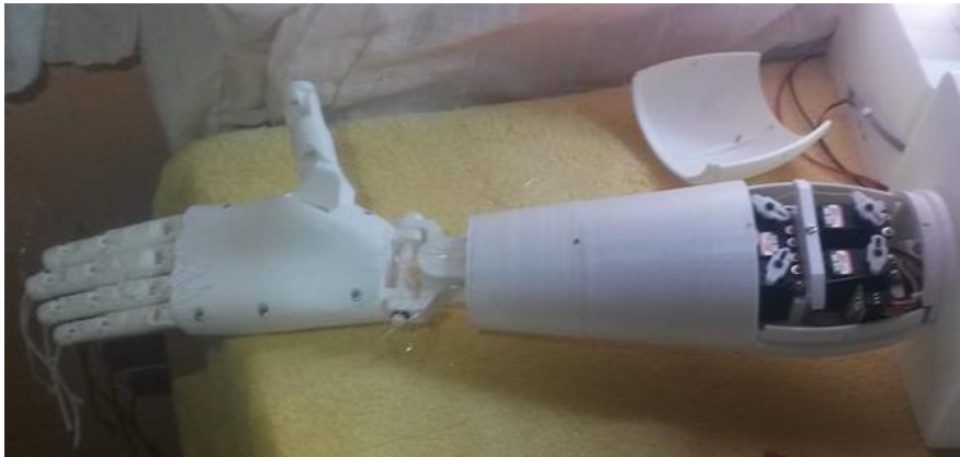
Figura 28-5. Ensamble del antebrazo
