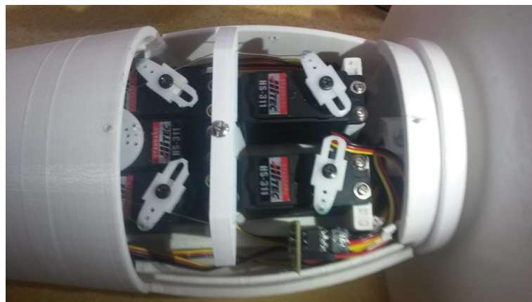
Figura 29-5. Templado de nylon en los servos
