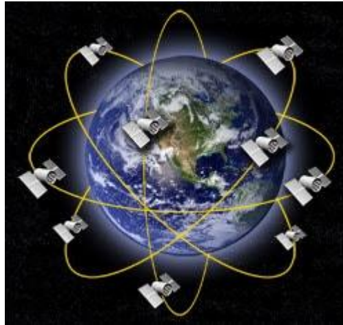
Figura 9-1: Segmento Espacial de GPS
