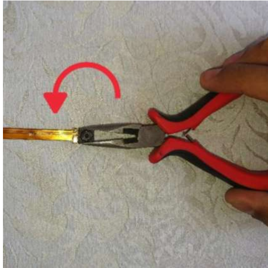
Figura 12-2: Proceso de enfoque de la cámara
