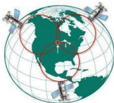
Figura 11-1: Triangulación de GPS
