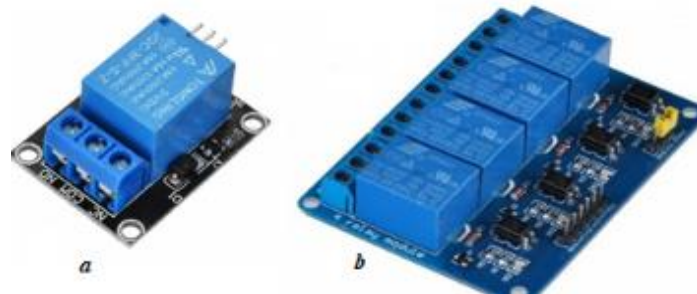
Figura 7-2: Conmutador a 5Vts
