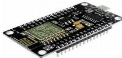
Figura 5-2: Tarjeta de desarrollo ESP8266 NodeMCU WiFi Realizado por: VÁSQUEZ, Christian 2018
