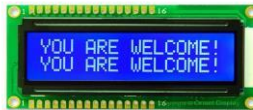
Figura 8-2: Pantalla de cristal líquido 16 x 2
