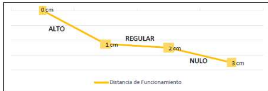
Figura 5-3: Rangos de funcionamiento NFC.
