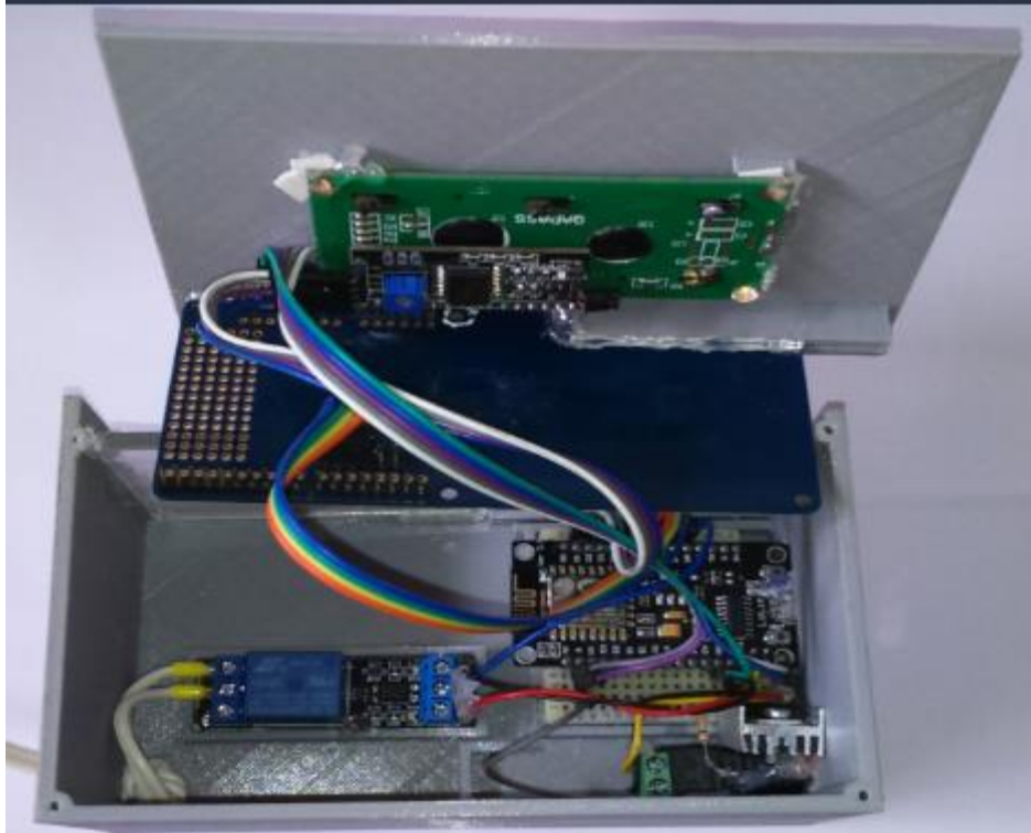
Figura 2-3: Parte interna del dispositivo control de acceso. Realizado por: VÁSQUEZ, Christian 2018
