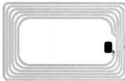
Figura 2-1: Unión de la antena con el chip Fuente:(Wahid et al., 2017,p 356).
