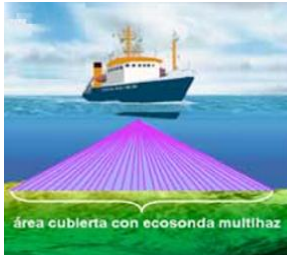
Figura 7-1: Sonda multihaz o haz simple
