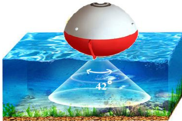
Figura 14-2: Patrón de Directividad del dispositivo iBobber.
