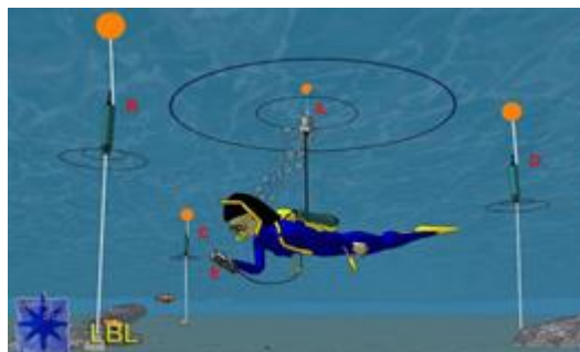
Figura 3-1: Sistema de posicionamiento LBL
