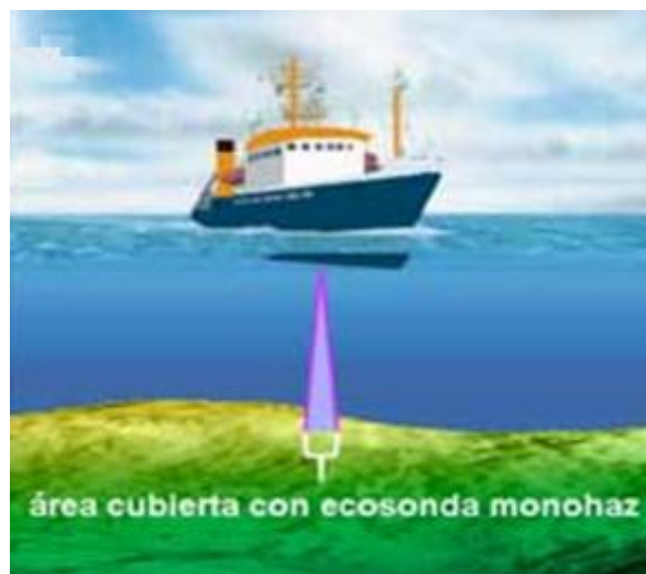
Figura 6-1: Sonda de haz simple
