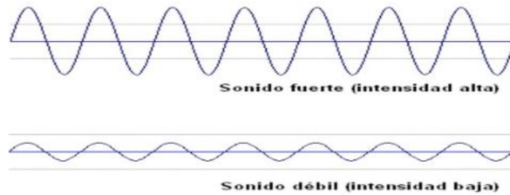
Figura 15-1: Diferencia de intensidad de una onda acústica
