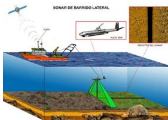
Figura 8-1: Funcionamiento de la sonda Lateral
