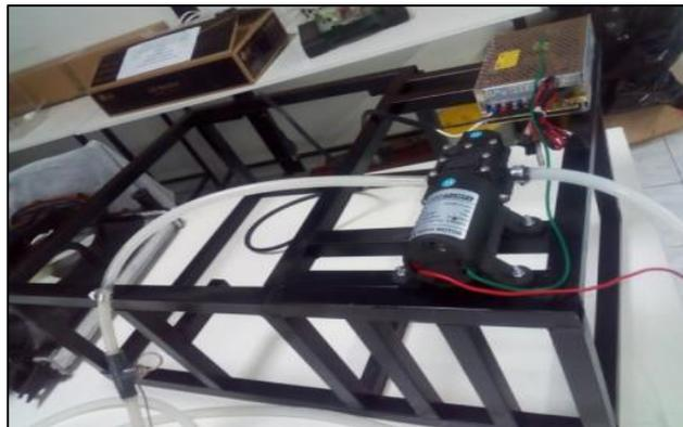
**Fotografía 9-2: Montaje de la bomba de diafragma y la fuente.**
