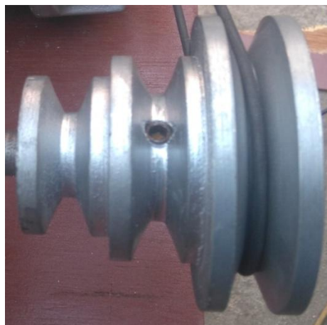
Figura 4-39. Polea de tres canales
