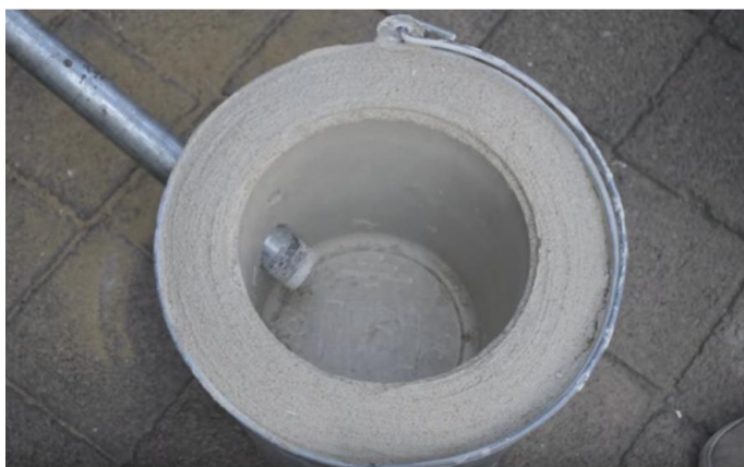
Figura 4-29. Horno de yeso y arena silica
