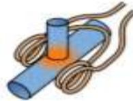
**Figura 27- 1:** Bobina helicoidal dividida
