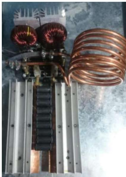
**Figura 29 – 2:** Placa del sistema de Inducción
