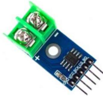
**Figura 12 – 2:** Convertidor Analógico MAX6675
