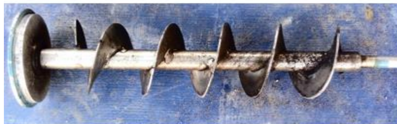
b. Implementación del tornillo sin fin en acero inoxidable
