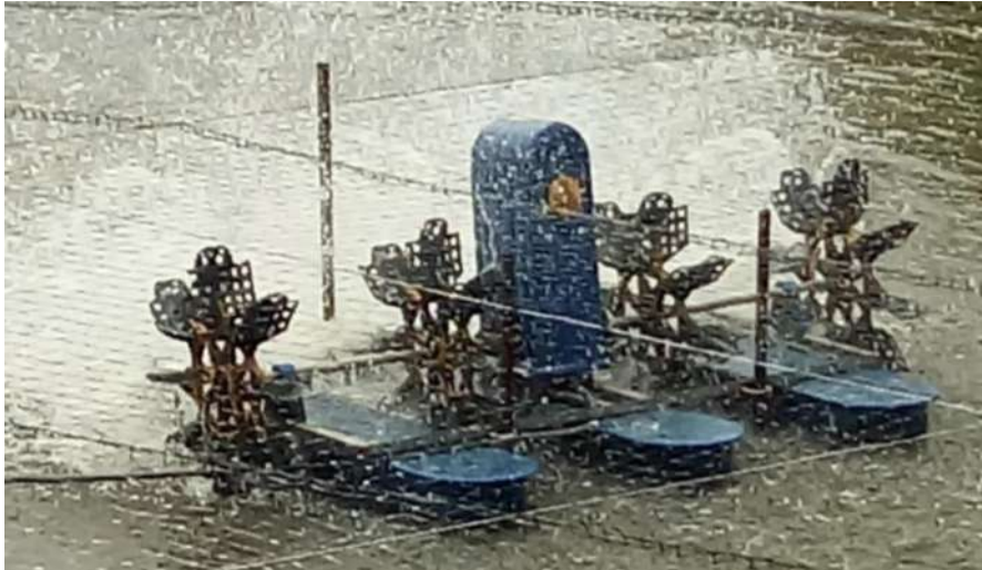
Figura 5-1: Aireador de cuatro paletas bifásico y su funcionamiento.
