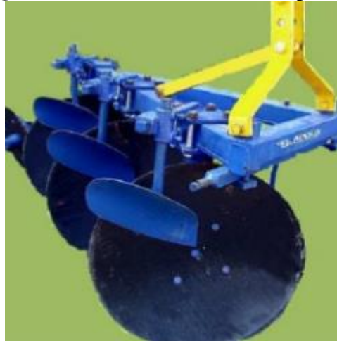
Figura 2-10 Arado tridisco con raspadores
