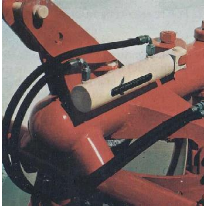
Figura 2-7 Arado de disco reversible de volteo hidráulico
