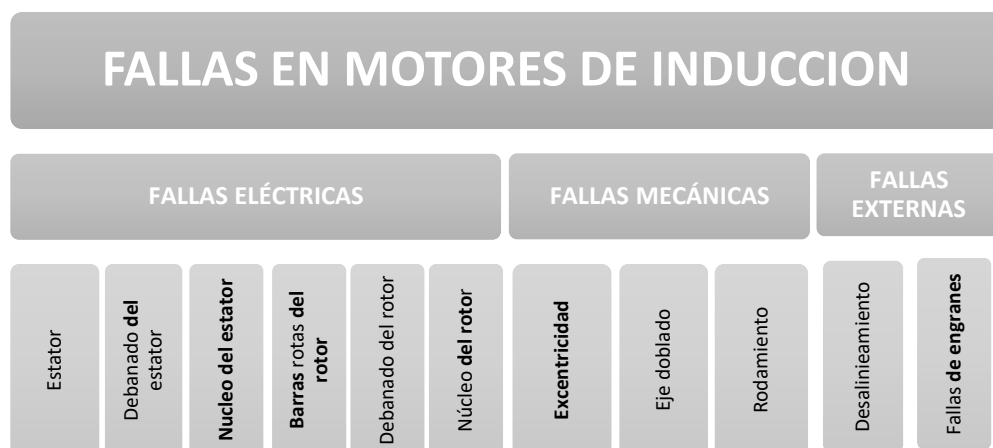
Figura 2-1 Clasificación de fallas en motores de inducción
