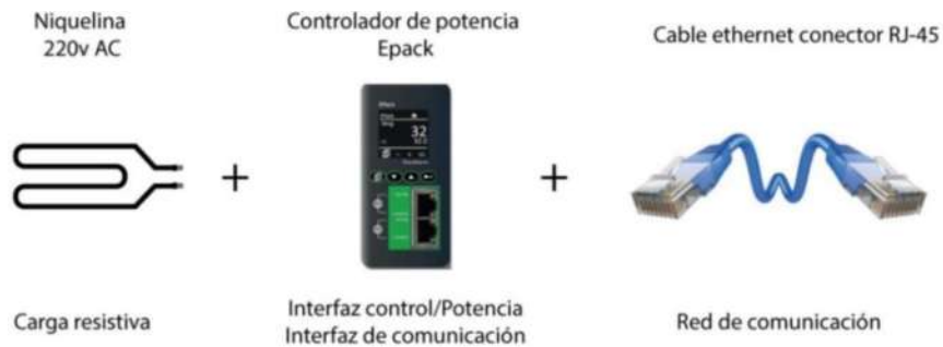
Figura 15-2 Esquema de comunicación de la etapa de hardware de una carga resistiva. Realizado por: Edwin Herrera, 2018.
