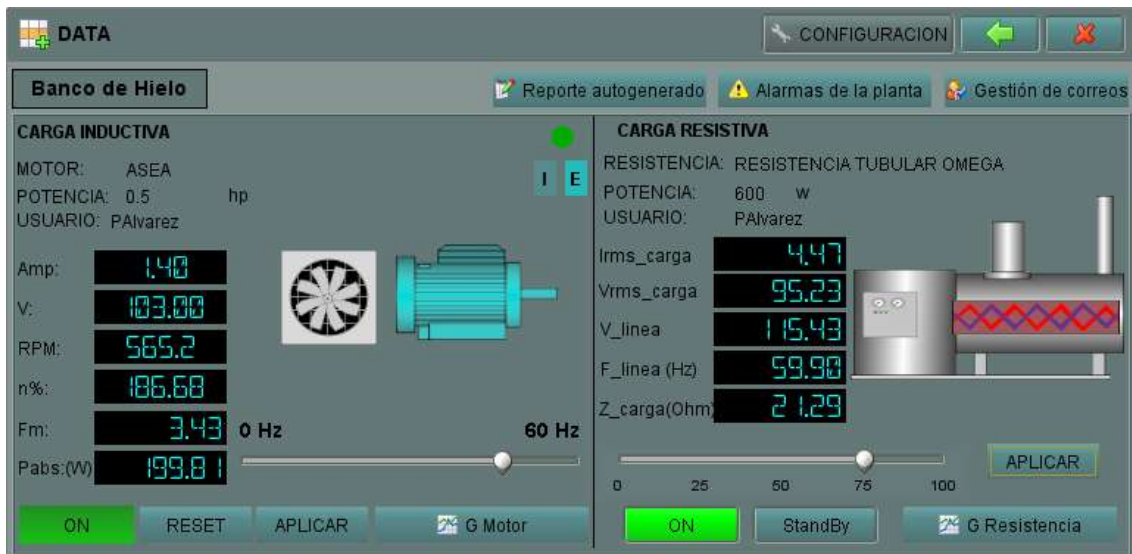
Figura 38-2 Scada de la planta Banco de Hielo. Realizado por: Edwin Herrera, 2018.
