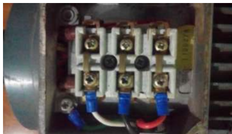
Figura 17-2 Conexión delta del motor. Realizado por: Edwin Herrera, 2018.
