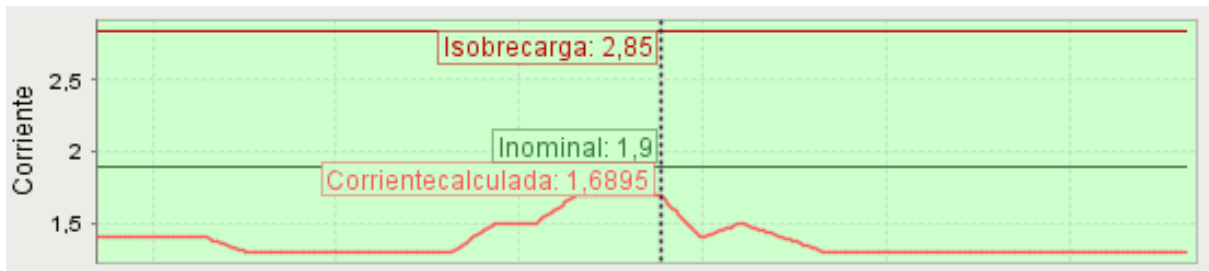
Figura 44-3 Gráfica de corriente en tiempo real bajo prueba con carga. Realizado por: Edwin Herrera, 2018.
