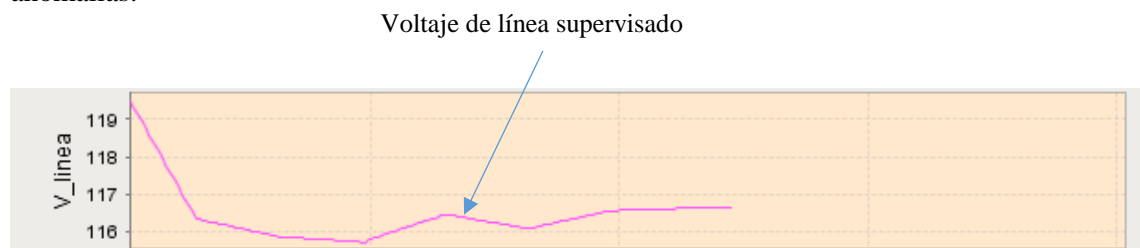
Figura 54-3 Señal supervisada de la tensión de la red. Realizado por: Edwin Herrera, 2018.
