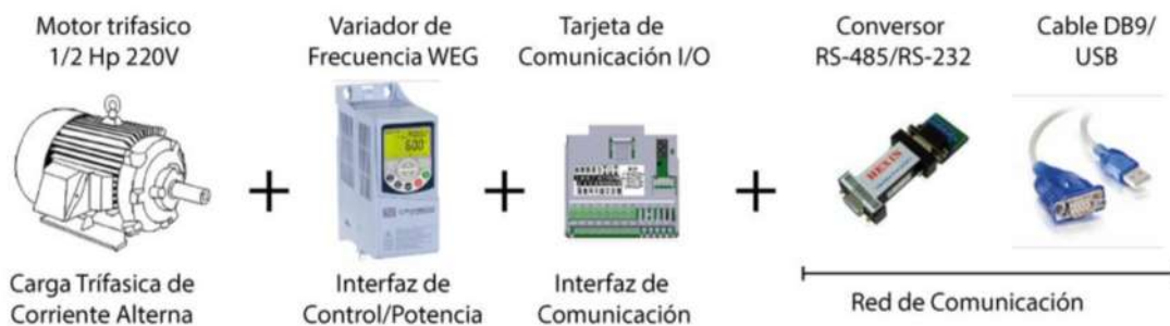
Figura 14-2 Esquema de comunicación de la etapa de hardware de una carga inductiva. Realizado por: Edwin Herrera 2018.
