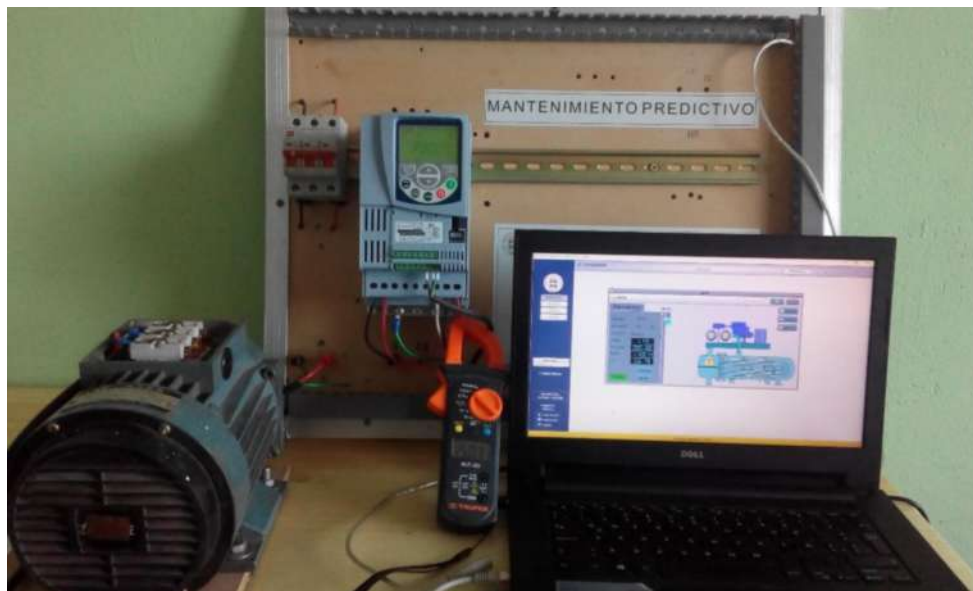
Figura 30-2 Toma de medidas de corriente con un multímetro Truper MTU-202 y el sistema Scada con el motor en marcha sin carga. Realizado por: Edwin Herrera, 2018.
