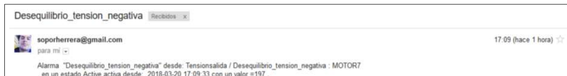
Figura 50-3 Notificación de alarma activa “Desequilibrio_tensión_negativa” por servicio de correo smtp. Realizado por: Edwin Herrera, 2018.
