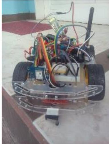
**Figura 2-4.** Conexiones prototipo / Sistema centralizado con Arduino Mega 2560
