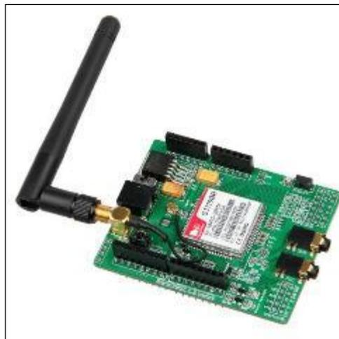
**Figura 15-3.** Shield Sim900 GSM/GPRS
