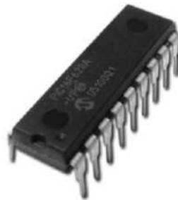
**Figura 1-1:** Microcontrolador PIC16F628A
