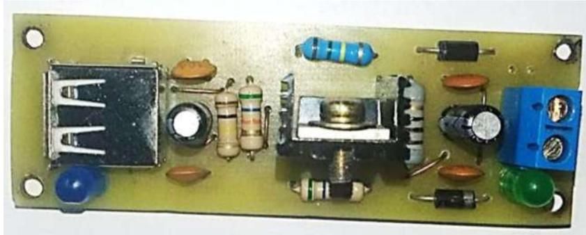
**Figura 10-2:** Elementos Placa Regulador de 5v
