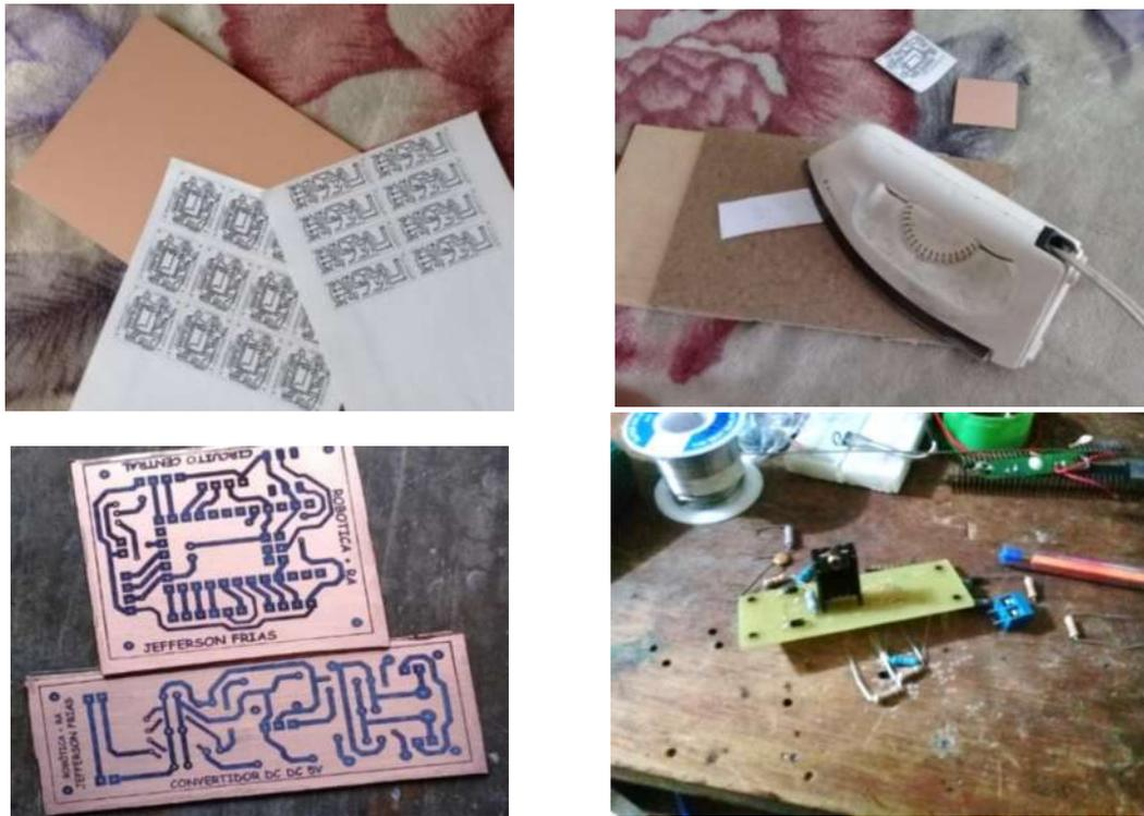
**Figura 9-2:** Proceso de Ruteado y PCB de placa electrónica módulo 5v
