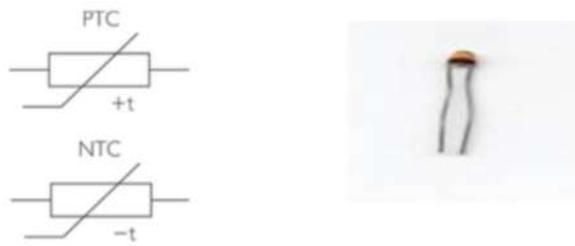
**Figura 12-1:** Tipos de sensores de temperatura
