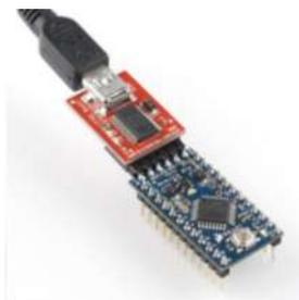
**Figura 25-2:** Dispositivo de Programación Arduino Pro Mini – FT232R
