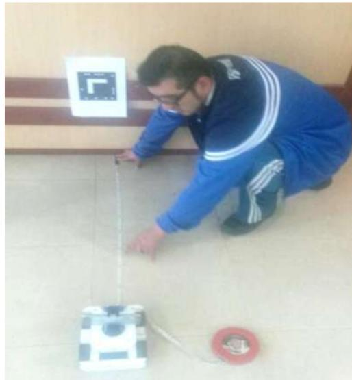
**Figura 11-3:** Medición distancia mínima Robot – Marcador
