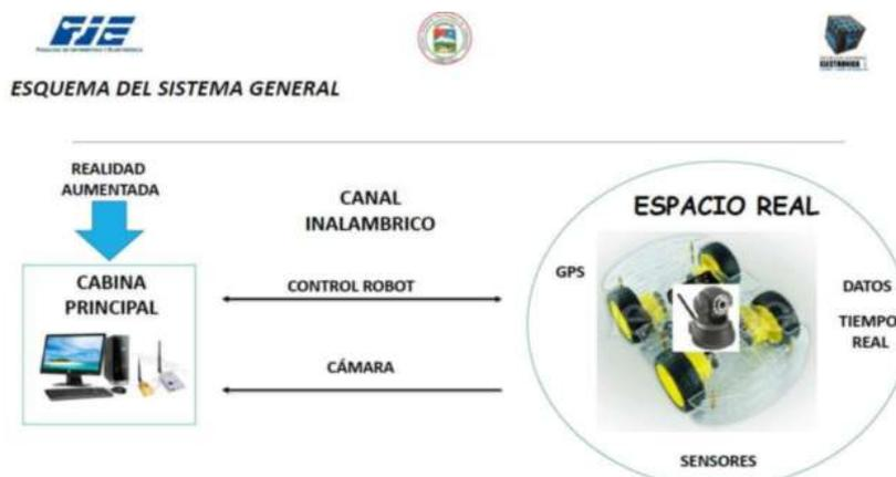
**Figura 22-2:** Modelo inalámbrico Robot Móvil – Realidad Aumentada
