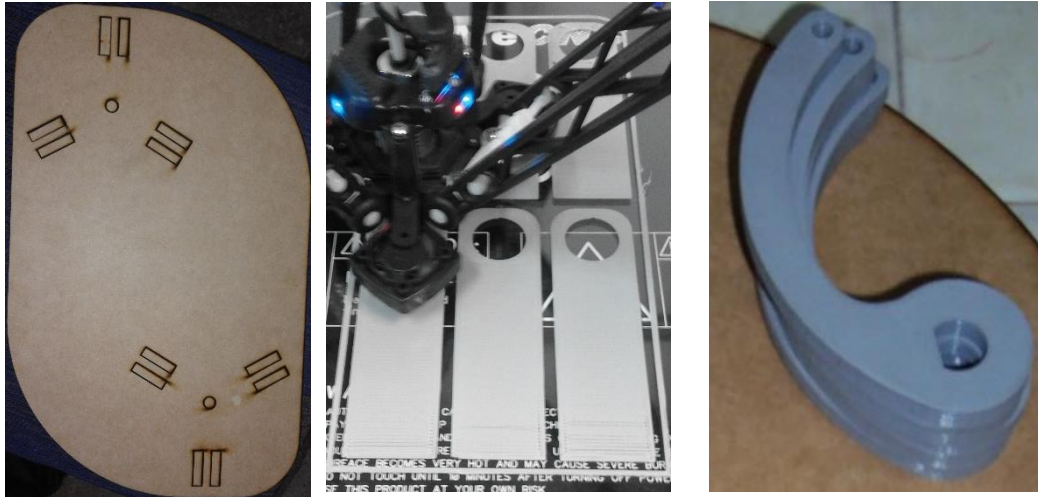
Figura 77-4: Base (madera MDF), columnas (PLA plomo) y brazos (PLA plomo)
