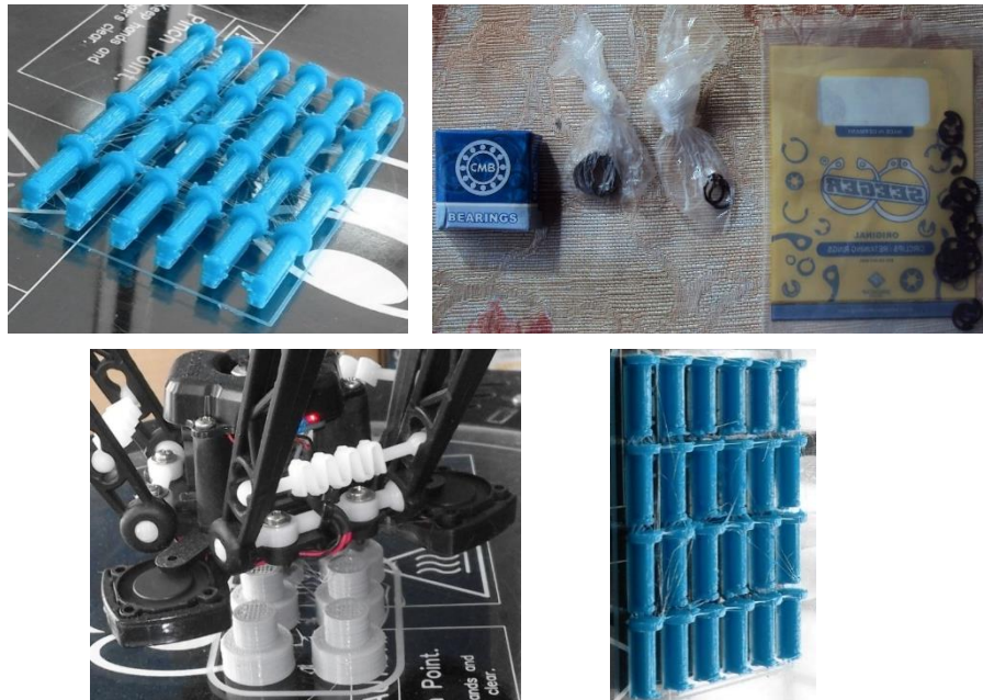
Figura 78-4: Ejes (PLA plomo), pasadores (PLA azul) y elementos de unión.
