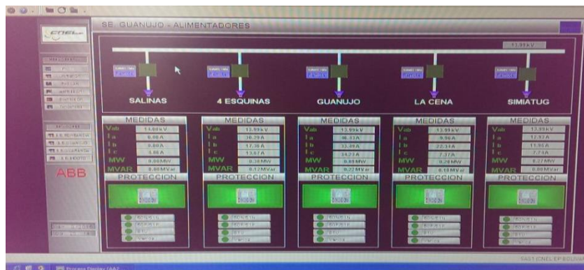
Figura 7-3. HMI del sistema Scada
