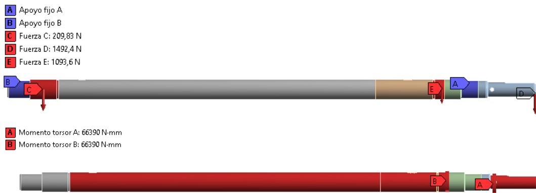
Figura 31-4. Soportes y cargas del modelo ANSYS del eje IN-EV
