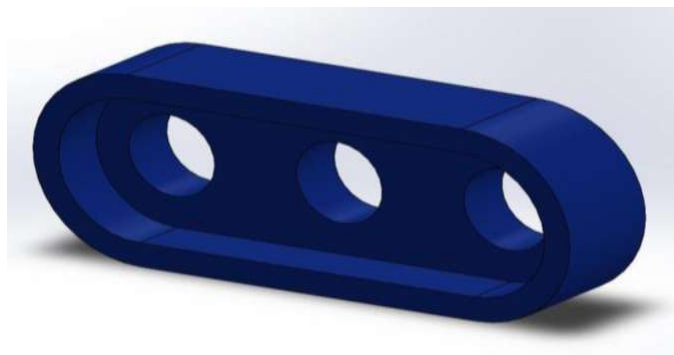
Figura 4-2: Diseño de la biela empleada en el prototipo
