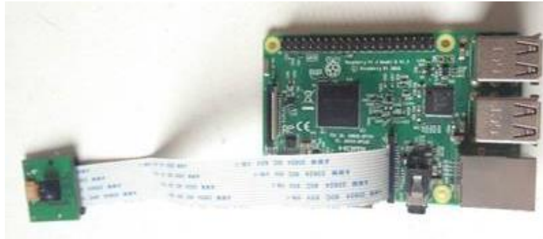
Figura 7-2: Conexión módulo cámara a la Raspberry mediante bus de datos CSI.
