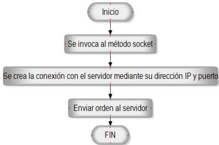
Figura 13-2: Diagrama de flujo de la comunicación a través de sockets (CLIENTE).
