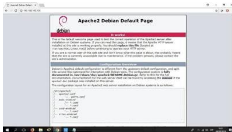
Figura 19-2: Verificación de la instalación de Apache.
