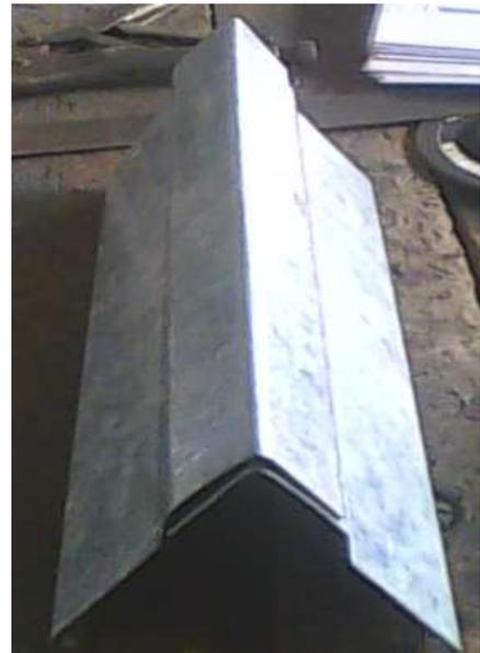
**Figura 6.9: Ensamble de bandeja central**
