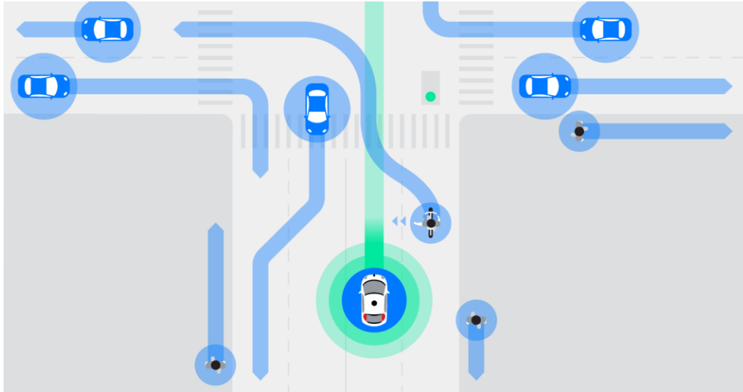
Figura 5-2: Predicción de comportamiento externo del WAYMO
